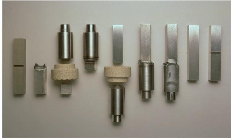
*Figura 2.54 Etapas del proceso de reconstrucción de una probeta Charpy por ASW [64]*
