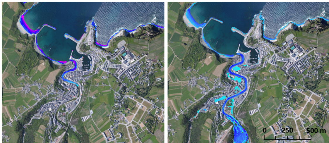
Figura 8. Análisis de sensibilidad en Luarca: inundación por MA (panel izquierdo) vs. Inundación por MA, caudal medio y precipitación (panel derecho).
