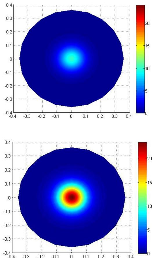
**Figura 1.** Distribución espacial de la radiación transmitida por el cultivo de cianobacterias en el foto-biorreactor, con una concentración de 0.202 kg/m<sup>3</sup>, haz gaussiano de 0.1 cm de radio eficaz, y a dos longitudes de onda diferentes: 530 nm (arriba) y 730 nm (abajo).
