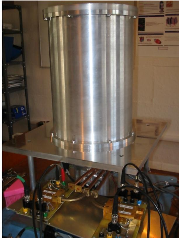
Figura 8.9. Integración de los módulos posteriores con los módulos frontales dentro del criostato de 30 GHz
