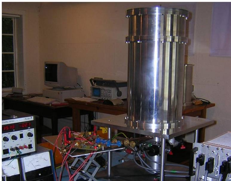
Figura 8.26. Integración de los módulos posteriores con los módulos frontales dentro del criostato de 44 GHz
