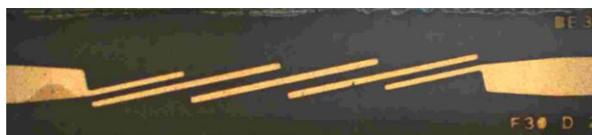
Figura 6.21. Fotografía del filtro paso banda en la banda Ka
