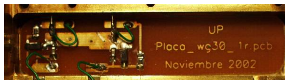
Figura 6.31. Circuito de protección para la polarización de dos MMIC LNA a 30 GHz
