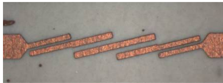
Figura 6.41. Fotografía del filtro paso banda de líneas acopladas a 44 GHz
