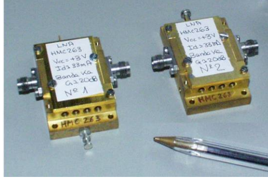
Figura 6.11. Fotografía de los útiles con conectores 2.4 mm con el amplificador HMC263 de Hittite
