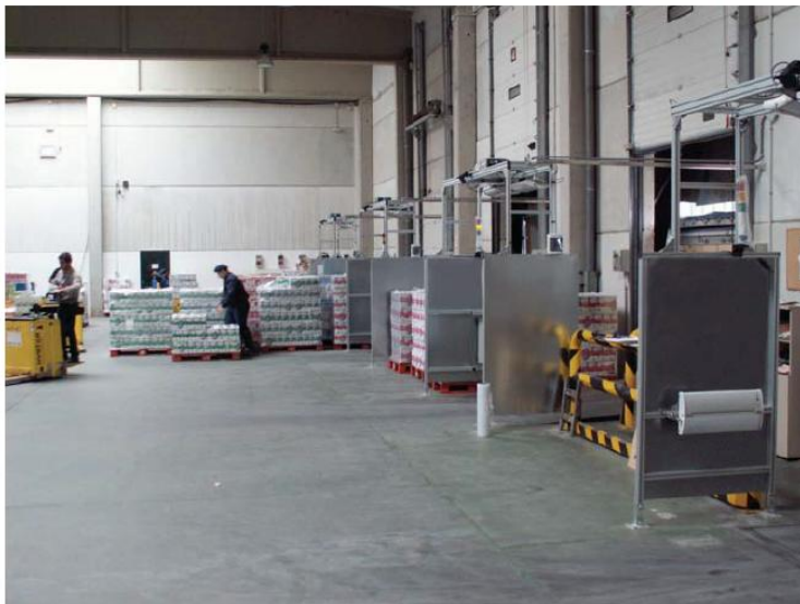
Figura 5.6: Aplicación de tecnología RFID en muelle de expediciones.
