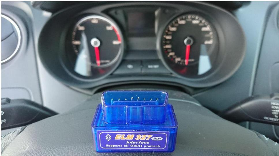
Figura 3. Dispositivo OBDII basado en el chip ELM327
