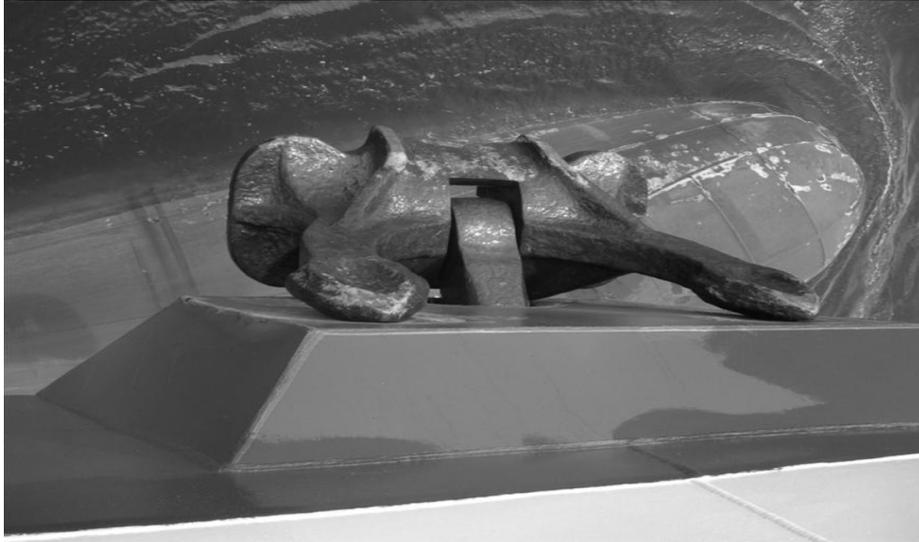
Ilustración 31- Posición de ancla estibada.
