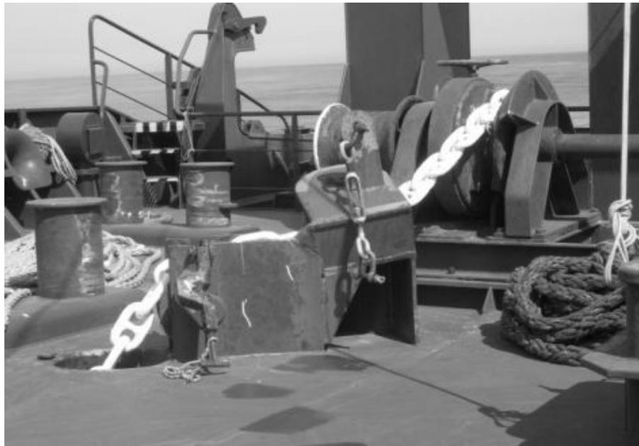
Ilustración 17- Trinca de la cadena y tensor zafados.
