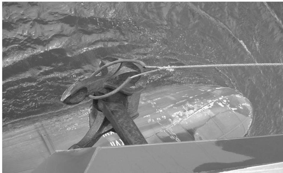
Ilustración 30- Colocación del ancla en posición para estibar.
