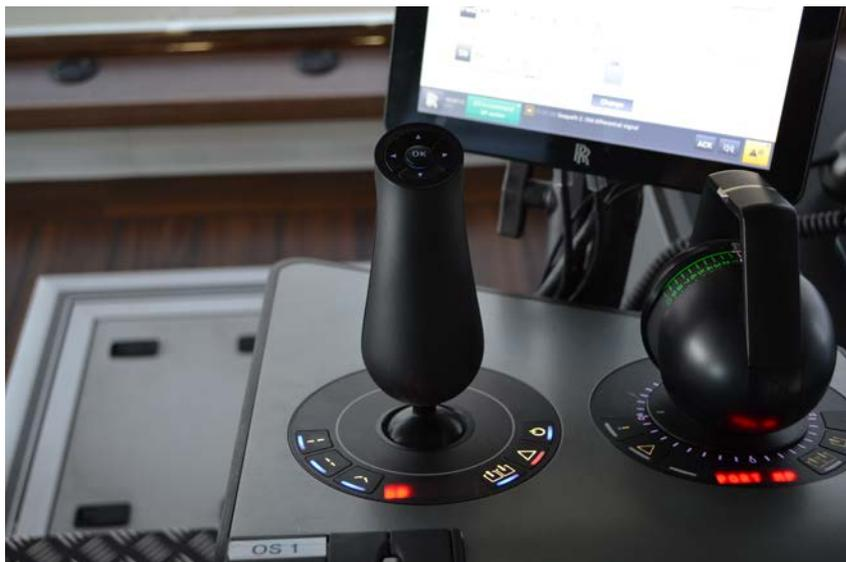
Fig.1: Joystick sistema Rolls Royce (foto del autor)
