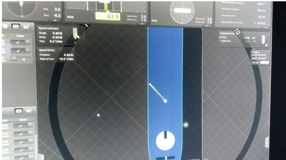
Fig.18: Pantalla de movimientos diagonales (foto del autor)
