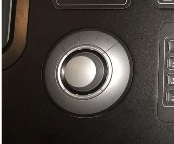
Fig.11: Pomo de cambio de heading (foto del autor)
