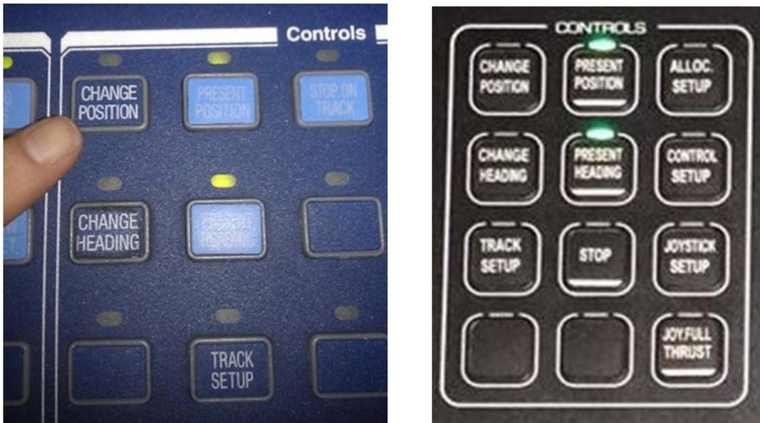
Fig.8 y Fig.9: Botoneras físicas correspondientes a un SDP21 y un K-pos respectivamente(foto del autor)
