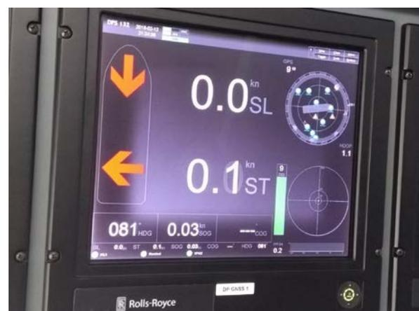
Figs.47 y 48: Pantallas receptoras de señales DGPS y GLONASS respectivamente (fotos del autor)
