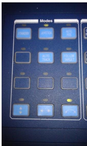
Fig.33: Detalle de activación del control de proa o "Yaw" (foto del autor)
