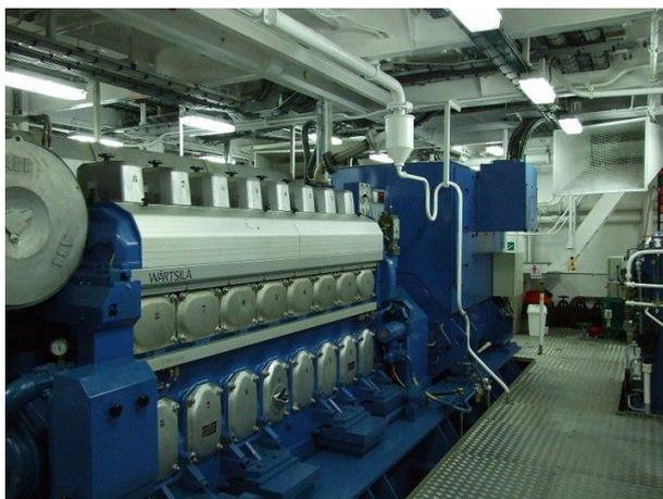
*Imagen 11: Motor de combustión interna alternativo de buque. Fuente: ingenieromarinero.com*
