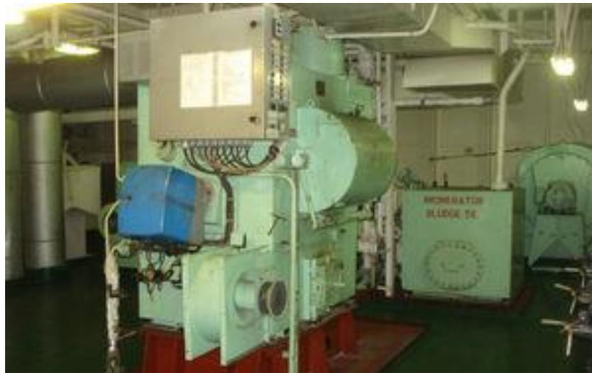
*Imagen 13: Incineradora de un buque. Fuente: NauticExpo.*
