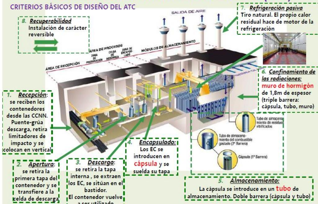
Imagen 136: Almacén temporal centralizado. Fuente: Almacenamiento de residuos radiactivos.
