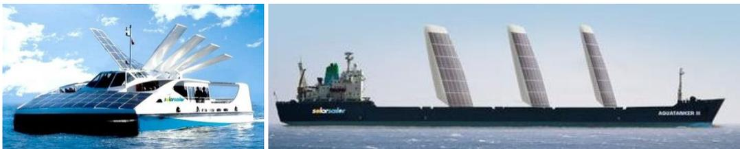
Imágenes 35 y 36: Prototipos de buque de pasaje (izquierda) y tanque (derecha) Solar Sail. Fuente: [bluebird-electric.net](http://bluebird-electric.net) y [treehugger.com](http://treehugger.com).
