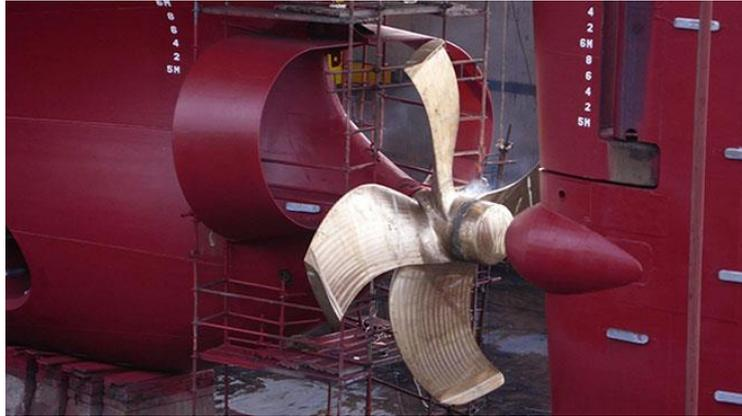
*Imagen 57: Hélice CLT. Fuente: diariodenautica.com.*
