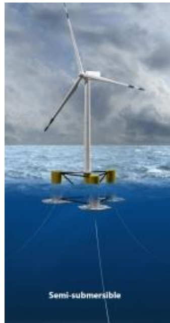
Figura 39: Aplicación de estructura semi-sumergible a la generación eólica offshore [24]
