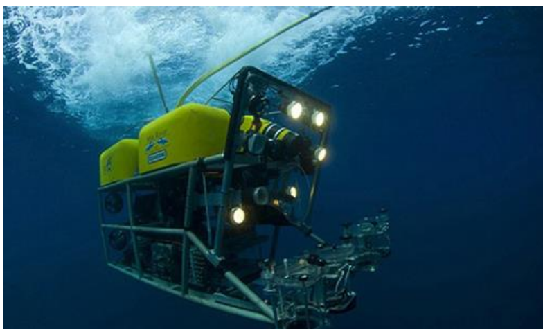
Figura 60: ROV en trabajo subacuático [36]
