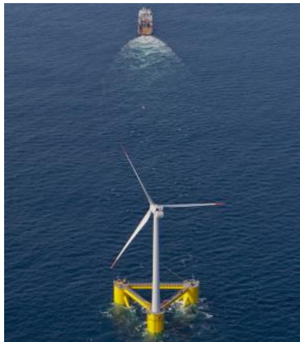
Figura 82: Transporte de la plataforma WindFloat [56]
