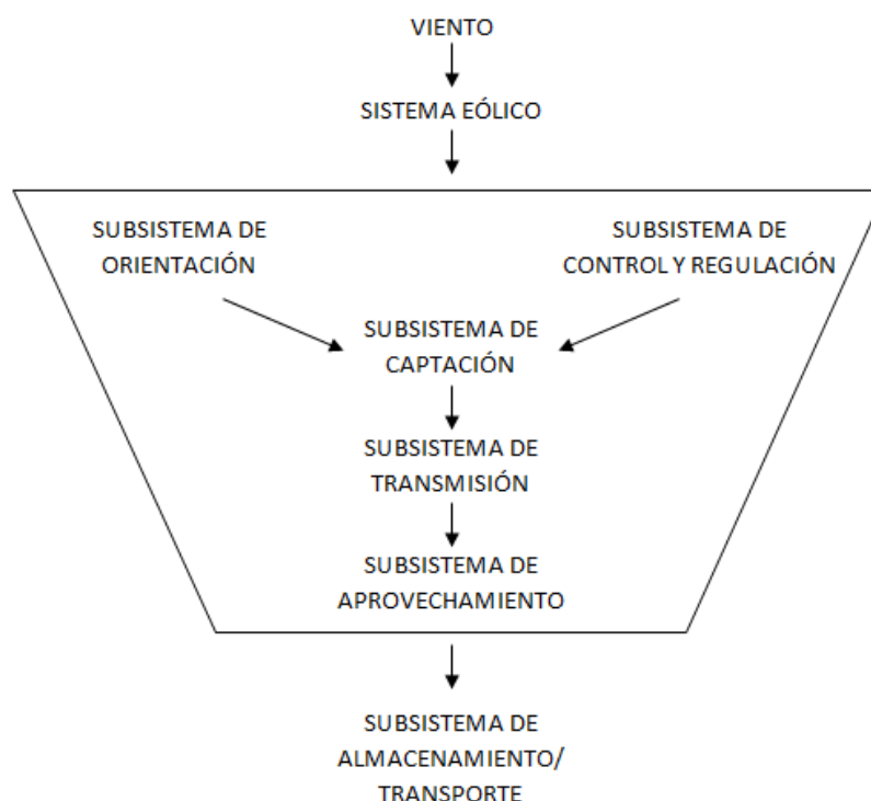
Figura 22: Subsistemas que conforman un aerogenerador
