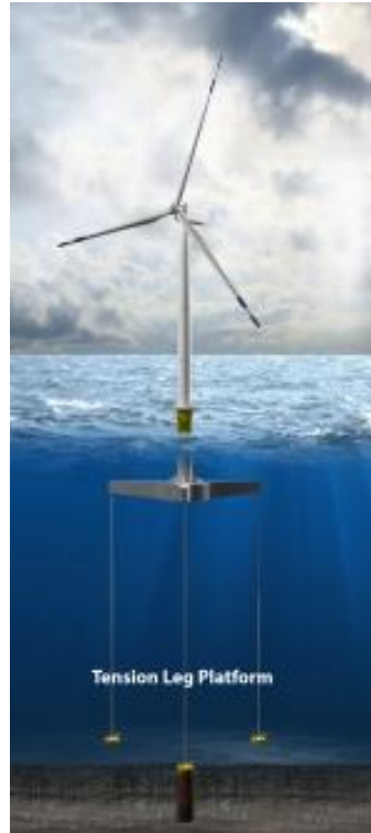
Figura 45: Aplicación estructura TLP a la energía eólica offshore [24]
