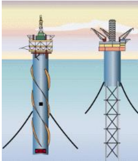
Figura 42: Esquema estructuras tipos spar tradicional y en celosía
