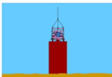
Figura 35: Esquema de una cimentación por succión
