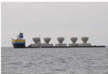
Las cimentaciones se transportan
