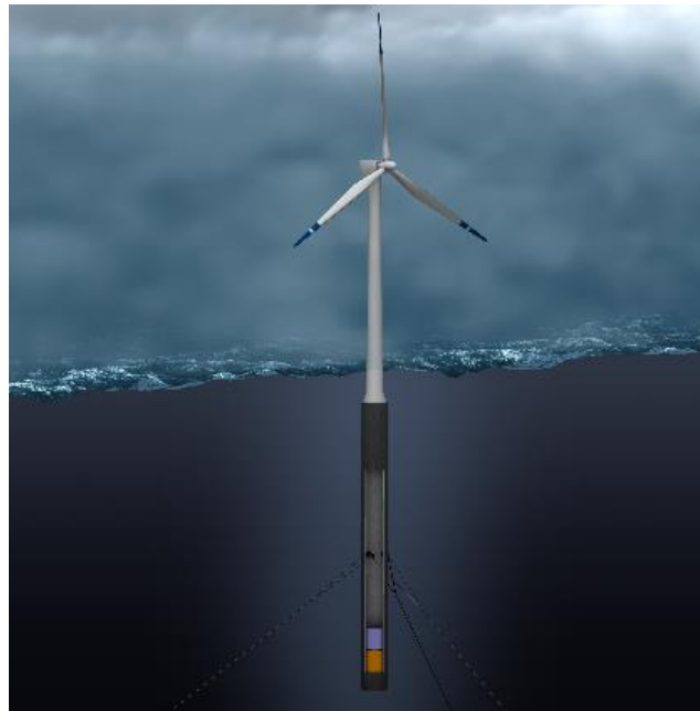
Figura 43: Aplicación de la tecnología spar a la energía eólica offshore [26]
