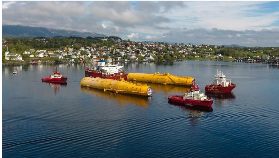
Figura 14: Plataformas Spar empleadas en el parque eólico Hywind Scotland [8]
