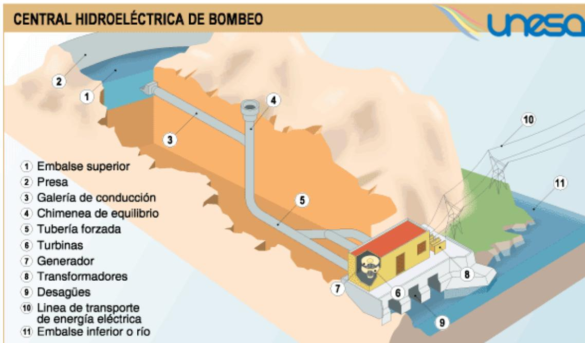
Figura 5: Central hidroeléctrica de bombeo. Fuente: unesa.
