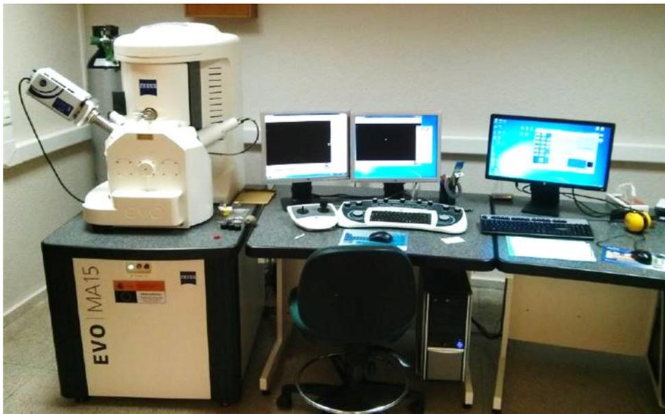
**Figura 3.19** Microscopio electrónico de barrido ZEIS EVO MA15.
