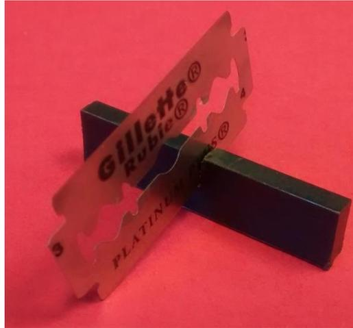
**Figura 3.10** Obtención de fisuras con cuchilla.
