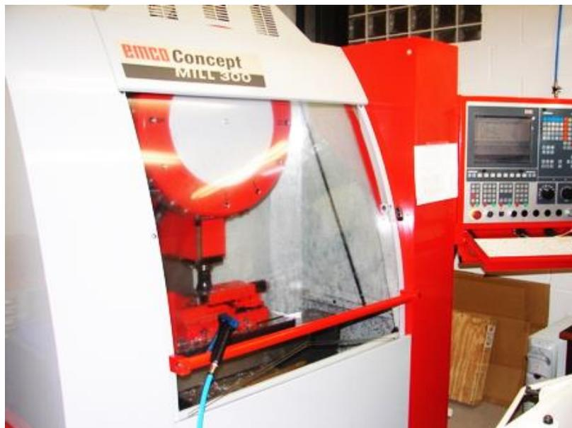
**Figura 3.9** Centro de mecanizado de control numérico CONCEPT MILL 300 utilizado para obtener las entallas (Instituto de Física de Cantabria, IFCA-UC).
