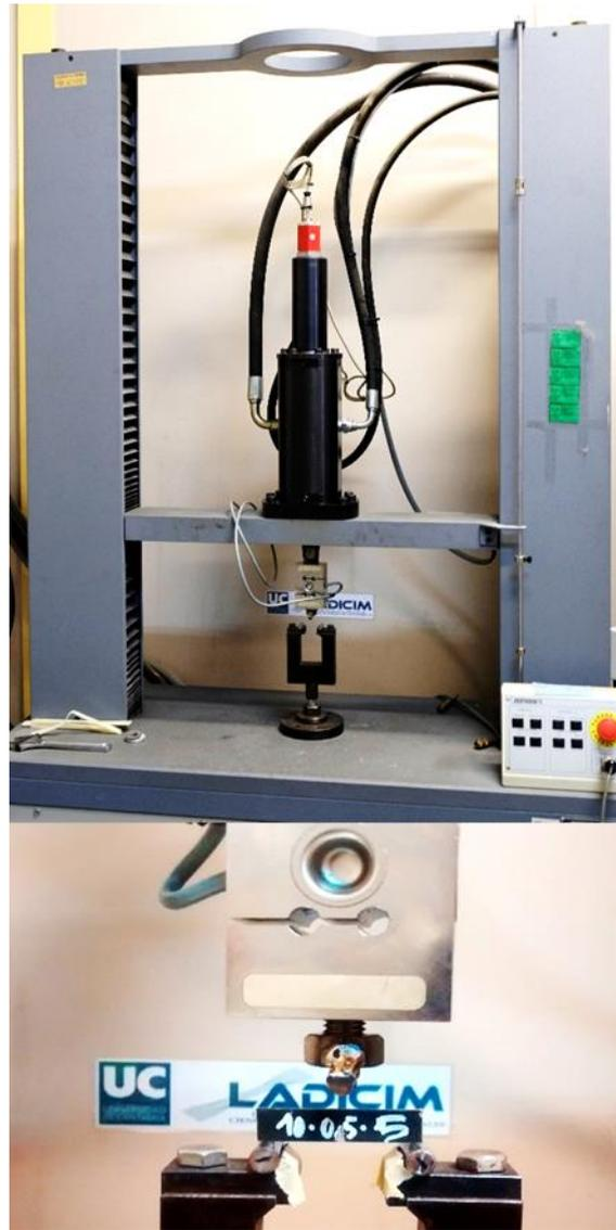
**Figura 3.13** Montaje experimental de los ensayos de flexión en 3 puntos.
