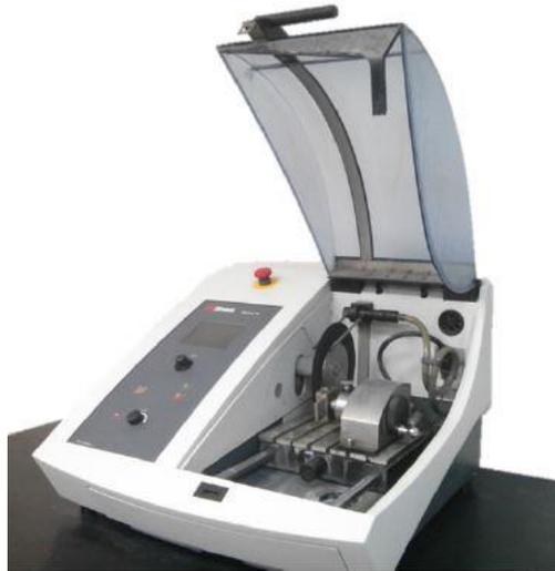
**Figura 3.8** Cortadora de precisión Struers Secotom 15.
