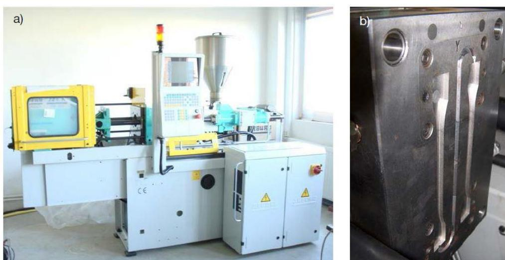
**Figura 3.4** Máquina de inyección (a) y molde (b) utilizados.
