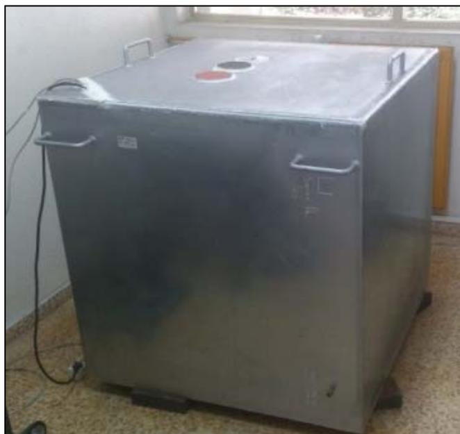
Fig.40: Cámara empleada para verificaciones de <sup>222</sup>Rn en aire.
