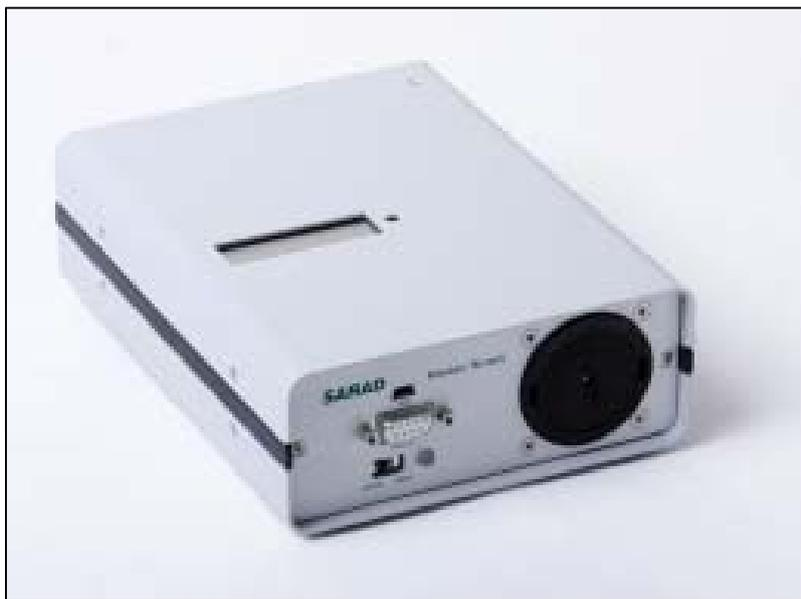
Fig.4: Equipo Radon scout para medida de  $^{222}\text{Rn}$  en aire.
