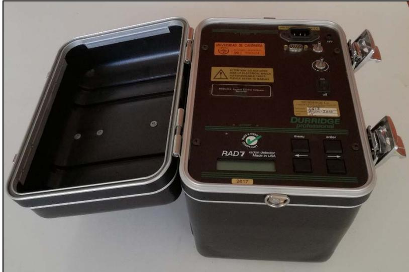
Fig.9: Imagen del equipo RAD7 radon detector.
