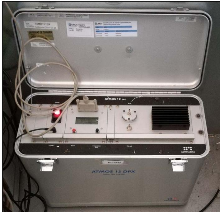
Fig.11: Equipo ATMOS 12 DPX funcionando dentro de la cámara empleada para verificación de equipos de medida de  $^{222}\text{Rn}$  en aire.
