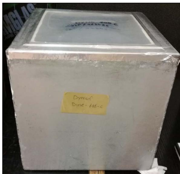
Fig.26: Caja de acero de 30 x 30 x 30 cm en cuyo interior se colocó el sistema de generación de  $^{222}\text{Rn}$  junto al Radon scout 1138.
