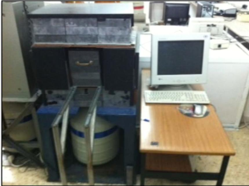
Fig.19: Espectrómetro gamma HPGe(Li).
