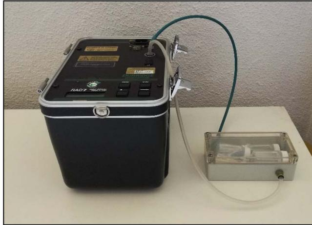
Fig.34: Equipo de RAD7 junto con caja de metacrilato con 6 viales en su interior.
