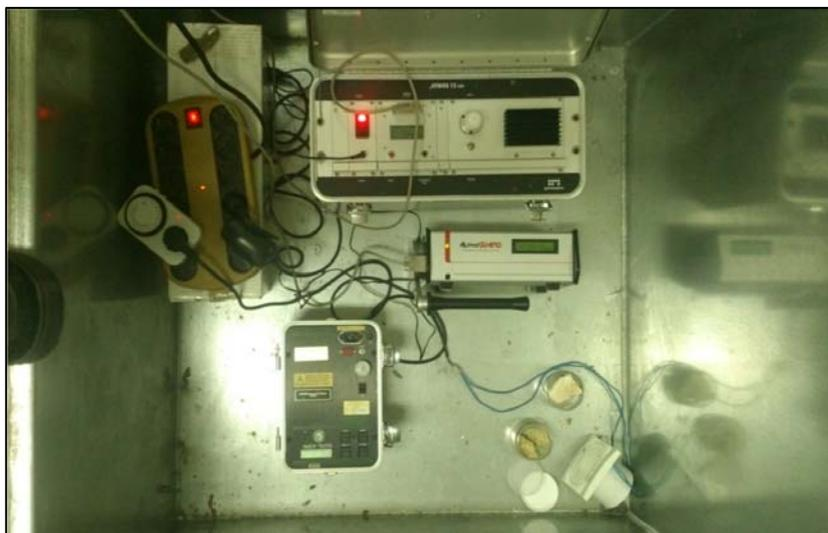
Fig.41: Interior de la cámara de Rn con fuentes de  $^{226}\text{Ra}$ , ventilador y equipos de medida.
