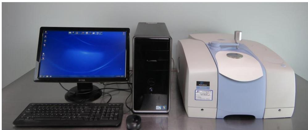
Figura 15. Espectrofotómetro de rayos infrarrojos.
