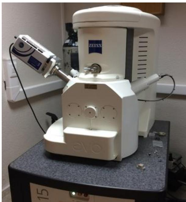
Figura 18. Microscopio electrónico de barrido.
