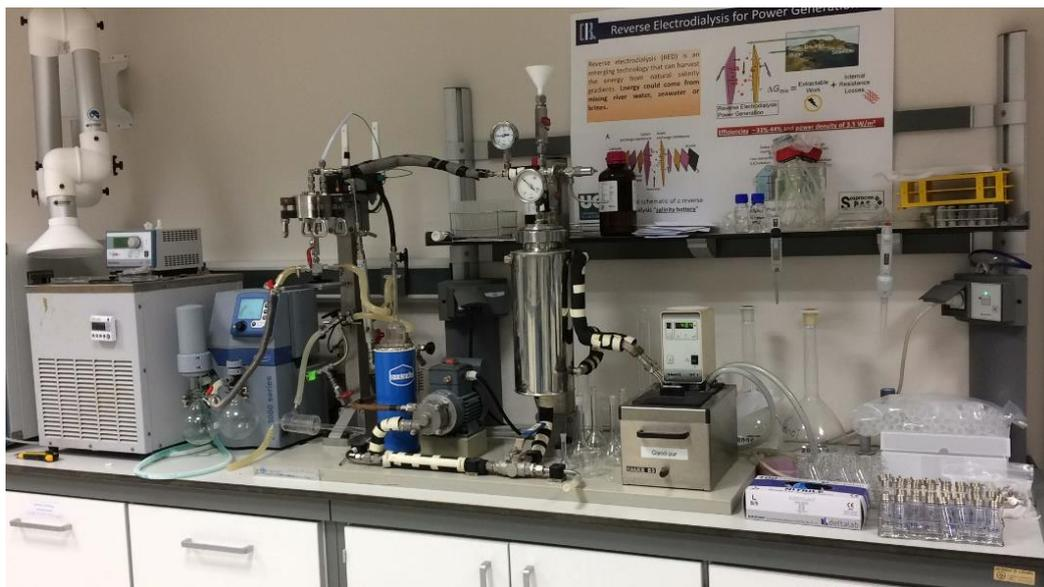
Figura 9. Instalación de pervaporación.
