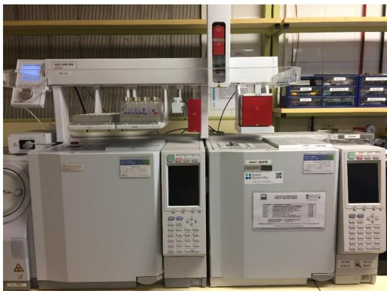
Figura 17. Cromatógrafo de gases.
