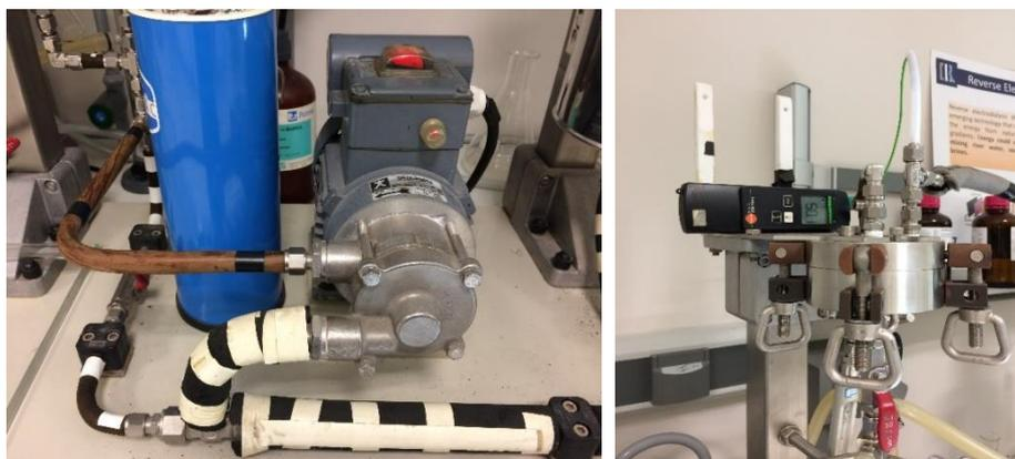
Figura 12. Imágenes correspondientes para (izquierda) bomba de circulación y (derecha) celda de membrana.
