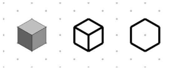
*Ilustración 16: Representación de un cubo y su forma exterior en proyección isométrica*
