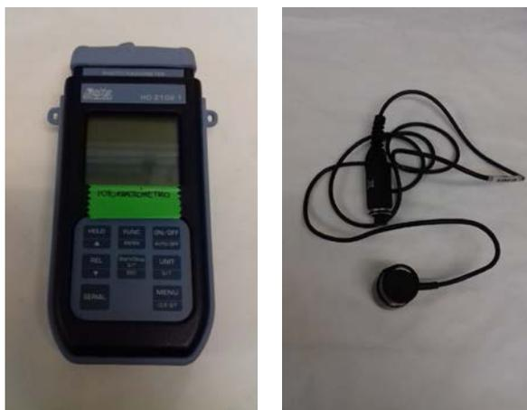
**Fig. 2.17. Foto-radiómetro HD 2102-1, Delta OHM (izquierda) con sensor móvil de irradiancia (derecha).**
