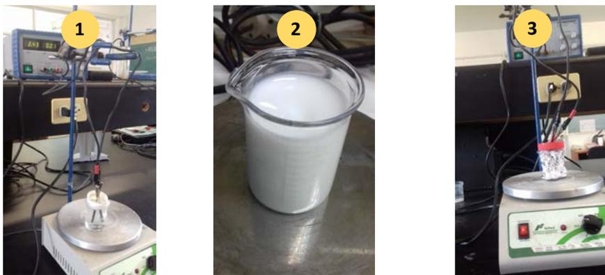
**Fig. 2.5. Procedimiento para la electrodeposición del nanomaterial de  $\text{TiO}_2$  P25 sobre la superficie del ánodo de grafito.**
