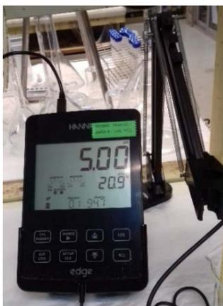
**Fig. 2.15. Equipo multiparámetro para la medición del pH (HANNA Instruments)**
