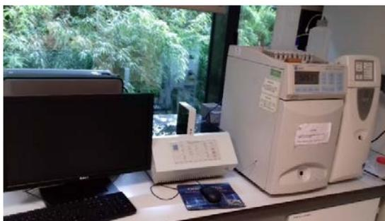
**Fig. 2.10. Cromatógrafo iónico ICS-1100 (Dionex).**
