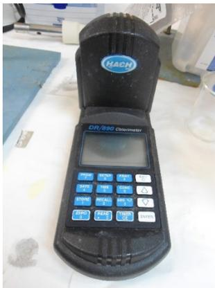
**Fig. 2.12. Colorímetro portátil DR/890 (HACH), para la determinación de cloro libre.**
