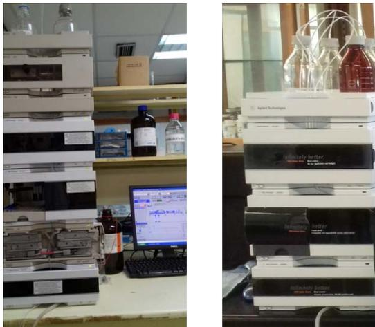
**Fig. 2.9. Cromatógrafo de líquidos de alta resolución (Agilent Technologies), modelo 1100 (izquierda) y 1250 Infinity (derecha).**
