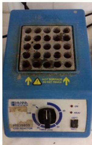
**Fig. 2.14. Digestor HI839800 (HANNA Instruments) para la medición de la DQO**
