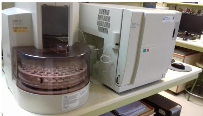
**Fig. 2.13. Equipo de carbono orgánico total TOC-V CPH (Shimadzu)**
