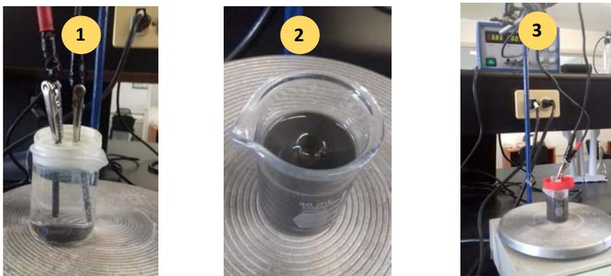
**Fig. 2.4. Procedimiento para la electrodeposición del composite  $\text{TiO}_2$ -Chi sobre la superficie del ánodo de grafito.**
