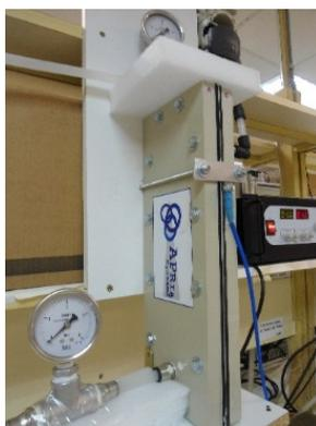
**Fig. 2.19.** Celda electroquímica de los sistemas de ELOX para el tratamiento de BPA y p-cresol.
