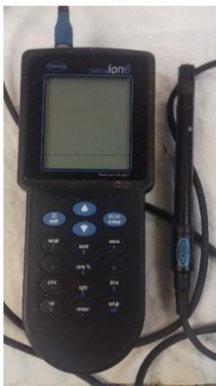
**Fig. 2.16. Conductivímetro portátil Sesion-6 (HACH)**
