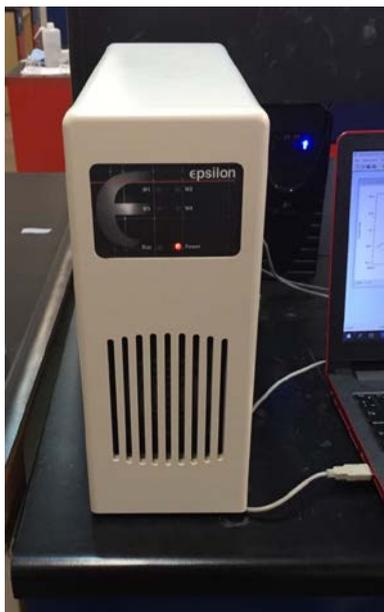
**Fig. 2.7. Equipo de potenciostato/galvanostato (Epsilon™)**
