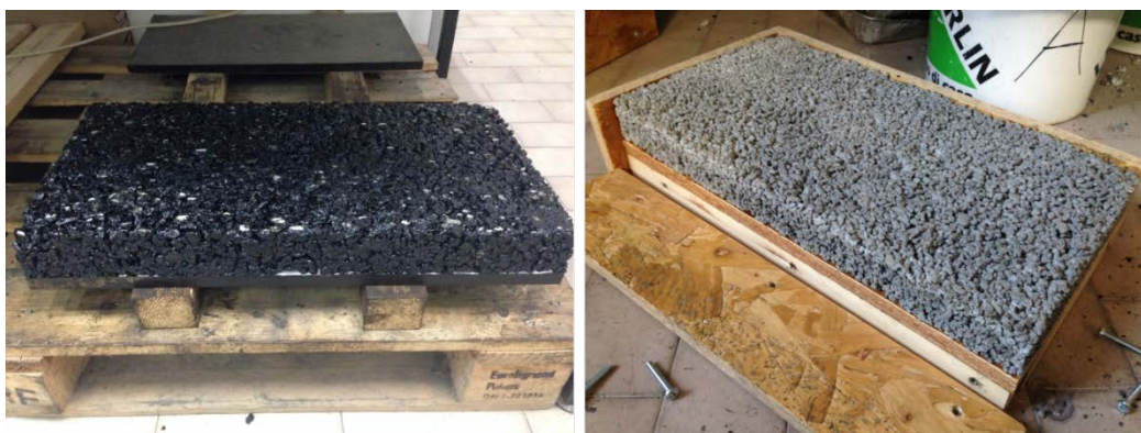
Figura 4: Materiales porosos de puesta en obra continua: Asfalto poroso (izquierda) y hormigón poroso (derecha)
