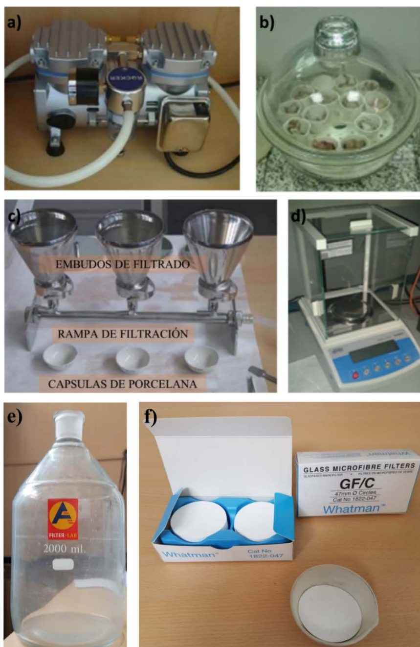
Figura 62: Equipo de filtración de SST: (a) bomba de vacío, (b) Urna de desecado, (c) Rampa de filtración y (d) Báscula de precisión, (e) Matraz Kitastos y (f) Filtros de microfibra de vidrio
