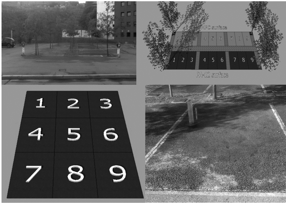
Figura 66: (Arriba) Aparcamiento experimental y esquema de las plazas monitorizadas y (Abajo) zonificación de las plazas para medidas de permeabilidad y foto de la medición de la permeabilidad en una de las plazas.
