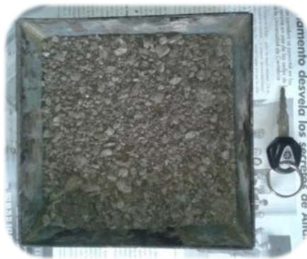
Figura 19. Material fresado que pasa por el tamiz de 16 mm
