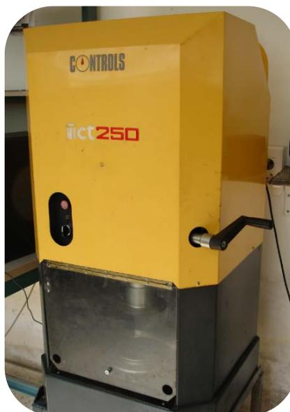
Figura 30. Máquina giratoria ICT250 de Controls
