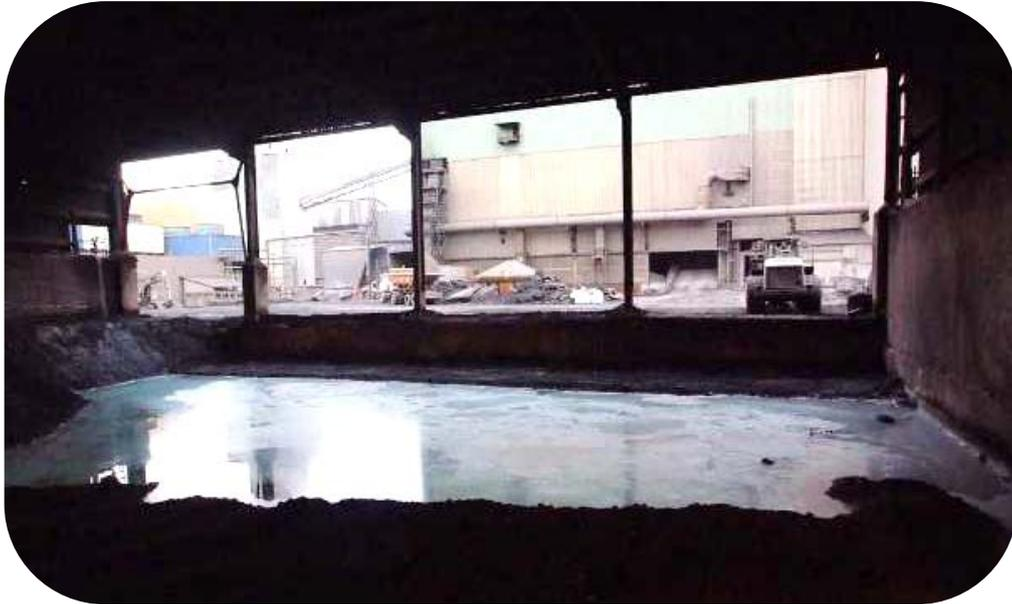
Figura 16. Hidratación de la escoria en piscina (cortesía de CODEFER)
