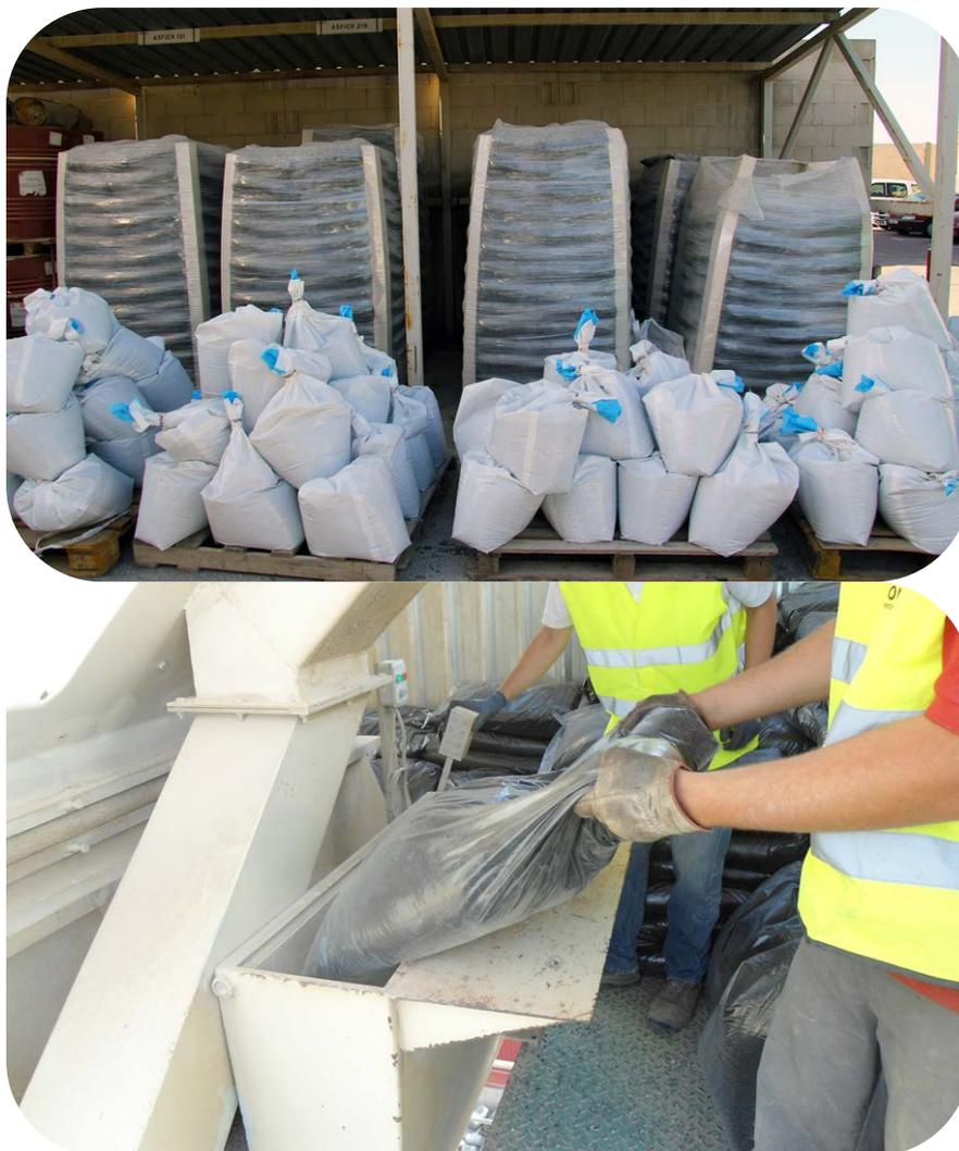
Figura 76. De arriba a abajo: acopio de polímeros y dosificador de planta asfáltica
