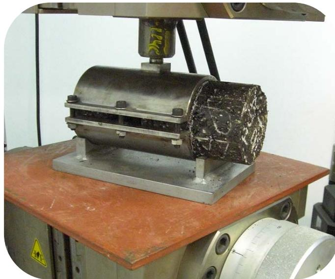
Figura 34. Ensayo LCB de adherencia estática
