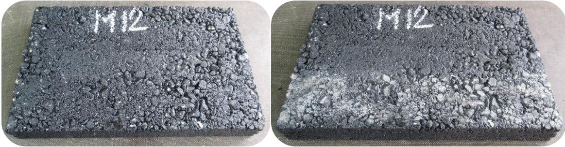
Figura 33. Probeta antes y después del proceso lijado
