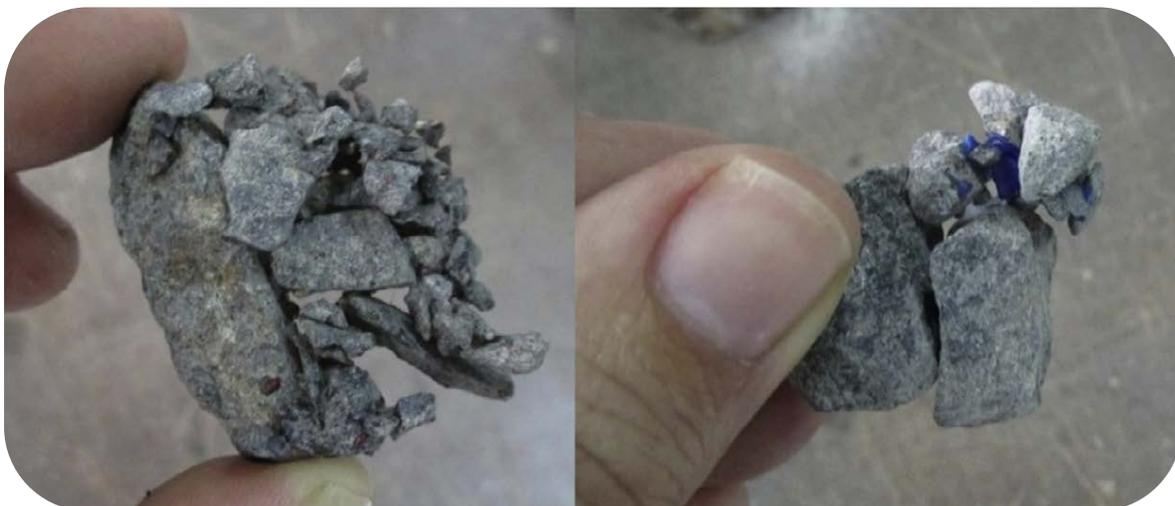
Figura 57. Efecto cohesivo del PE y PP sobre los áridos
