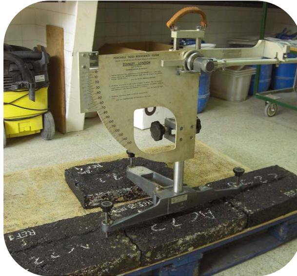
Figura 31. Ensayo de fricción con el péndulo TRRL en laboratorio
