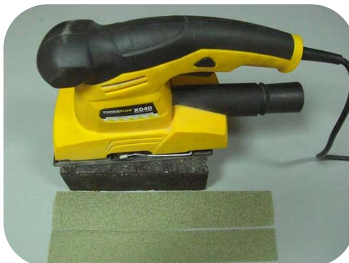
Figura 32. Equipo de lijado y muestra de papel de lija utilizados para el desgaste de las mezclas.
