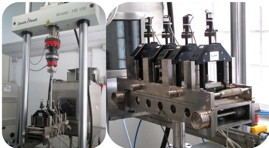
Figura 29. Dispositivo del ensayo de rigidez por flexión en 4 puntos
