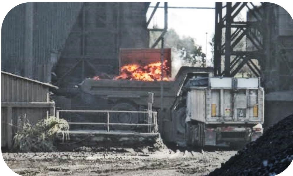
Figura 14. Carga de la escoria para su transporte a la zona de tratamiento (cortesía de CODEFER)
