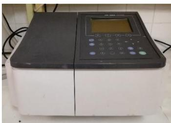
**Fig. 2.8. UV-1800 spectrophotometer.**
