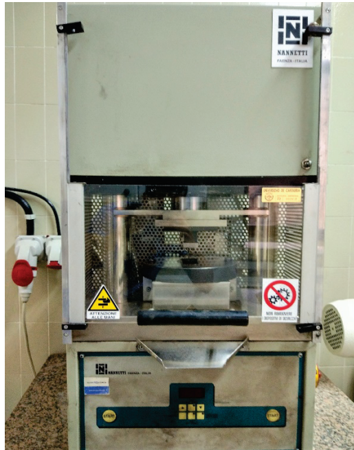
Figura 3. Prensa hidráulica Nanetti, modelo Mignon SS/EA.
