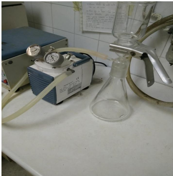
*Figura 10. Equipo de filtración Millipore de muestras*
