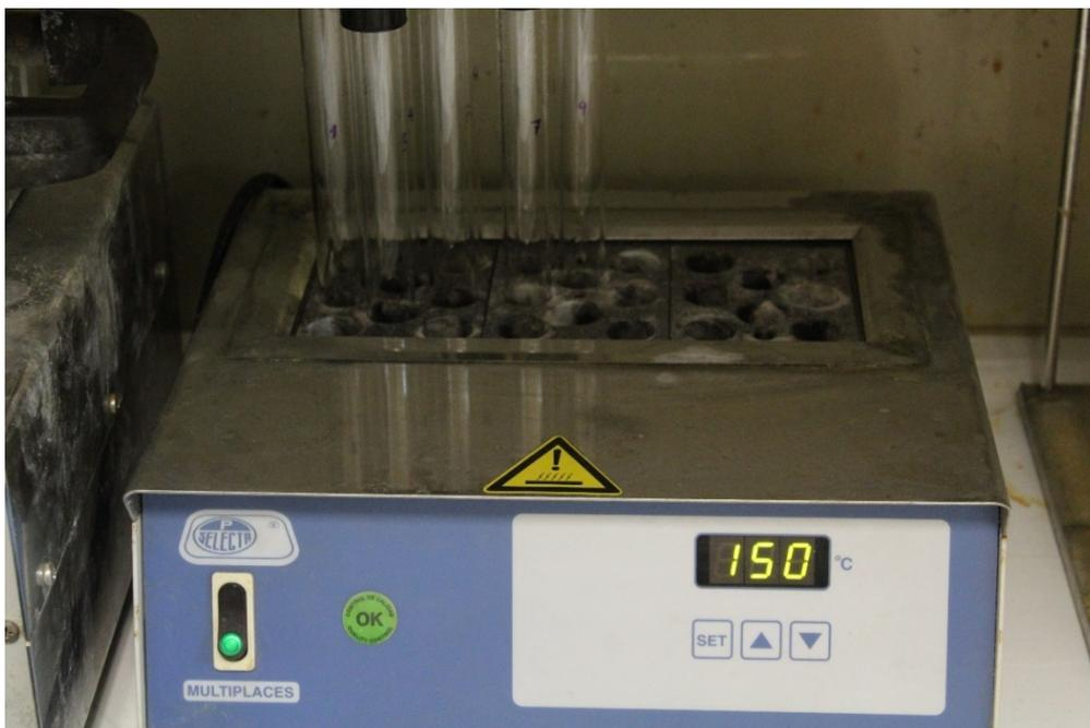
Figura 11. Digestor P-Selecta "Multiplaces" precalentado a 150°C, con tubos de digestión
