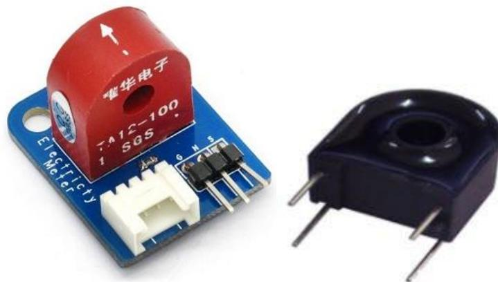
*Figura 9. Transformadores toroidales.*
