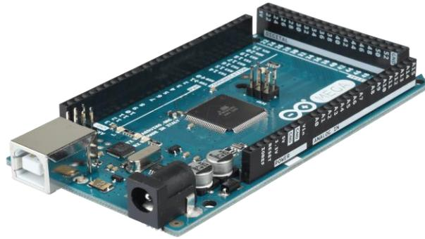
Figura 3. Arduino Mega.
