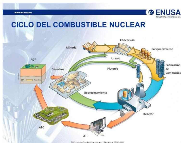
Figura 7.5: Se observa la combinación del ciclo cerrado y el ciclo abierto, una vez pasa el combustible gastado al ATC. Fuente: Enusa
