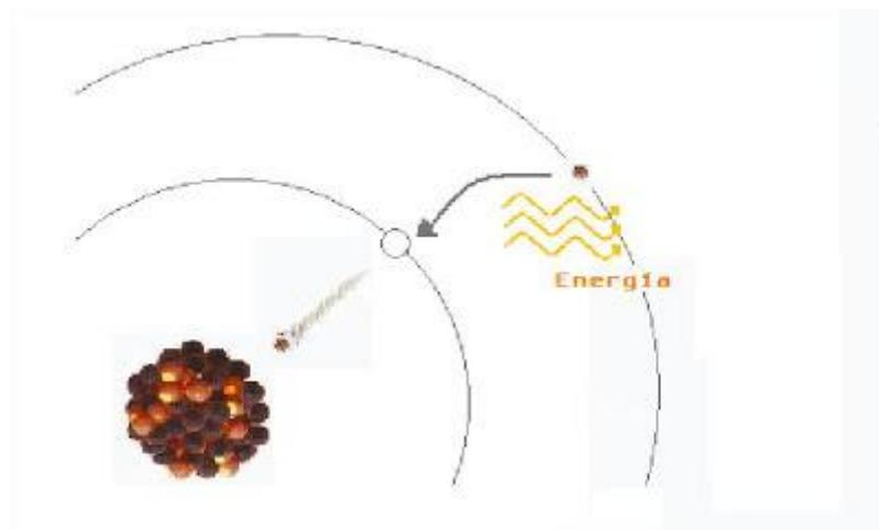
Figura 4.5: Emisión de rayos X por caída de electrón orbital interno
