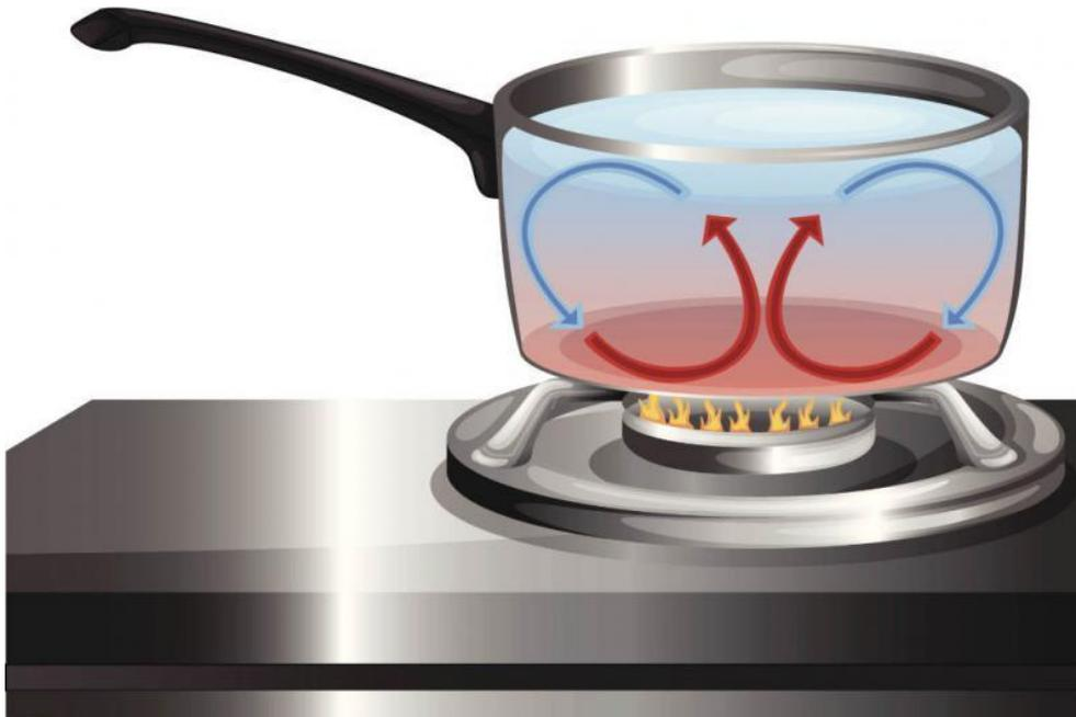
Figura 5.7: Transferencia de calor por convección del agua del interior del recipiente.
