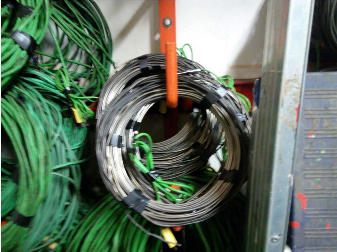
**Figura 47. Termopares tipo K encamisados. Fuente: ENSA**
