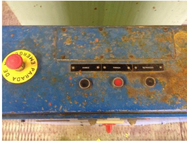
**Figura 66. Pulsadores de avance, retroceso y parada. Fuente: ENSA**
