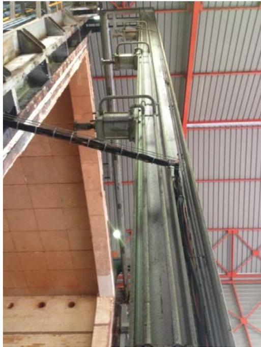
**Figura 68. Cilindros neumático superiores de la puerta. Fuente: ENSA**
