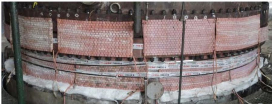
**Figura 34. Disposición de mantas eléctricas en función de la soldadura. Fuente: intec-heat**
