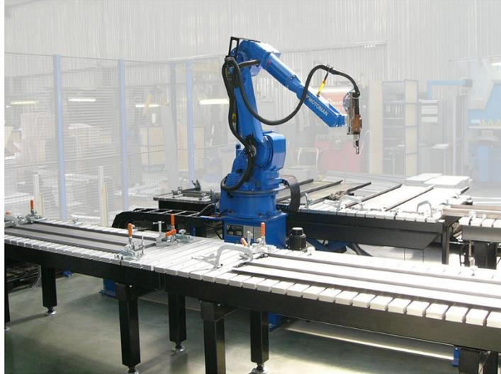
**Figura 26. Soldadura automatizada. Fuente: Förster Welding**
