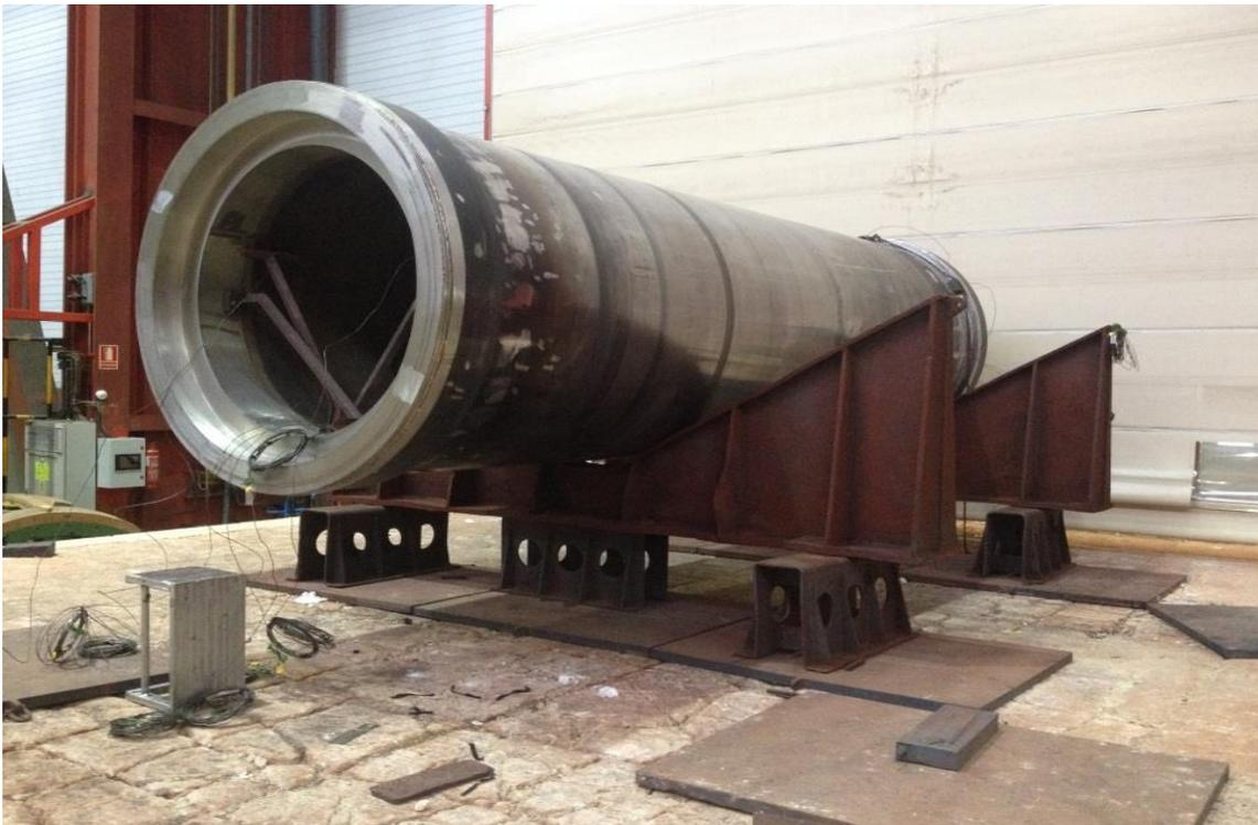
**Figura 63. Pieza preparada para tratamiento térmico. Fuente: ENSA**
