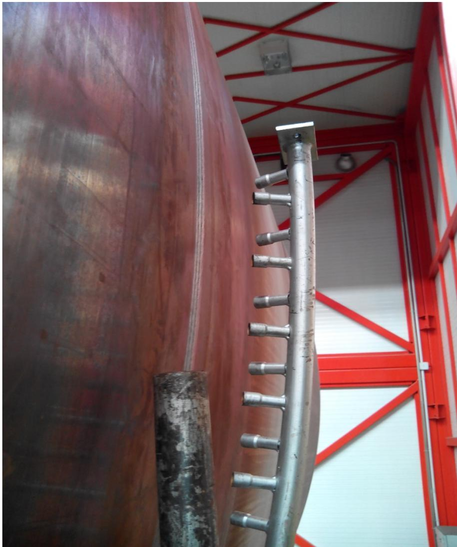
**Figura 3. Mecheros de gas que mantienen el gradiente térmico en soldaduras. Fuente: ENSA**
