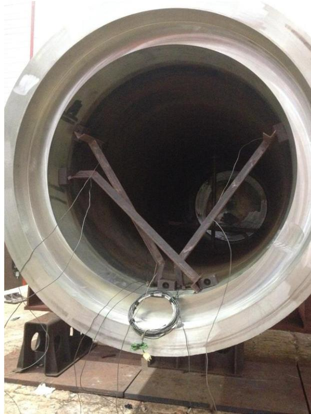
**Figura 56. Termopares de tipo "K" colocados. Fuente: ENSA**
