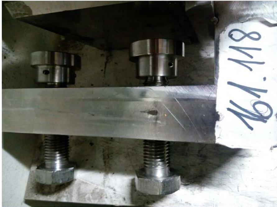
**Figura 85. Detalle del utillaje creado fijador para la fijación de la pieza. Fuente: ENSA**
