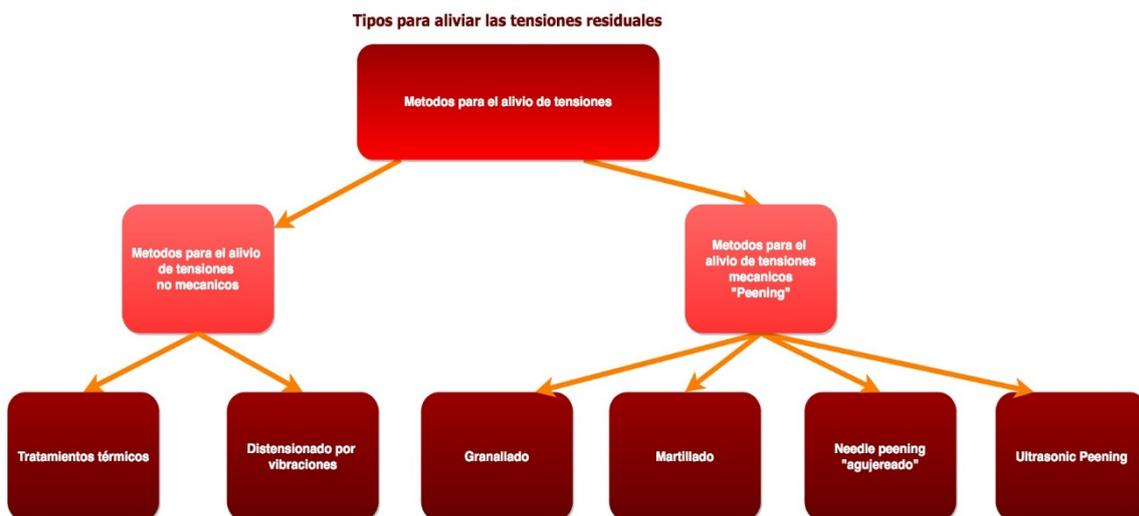
**Figura 28. Métodos existentes para lograr el alivio de las tensiones residuales. Fuente: Elaboración propia**
