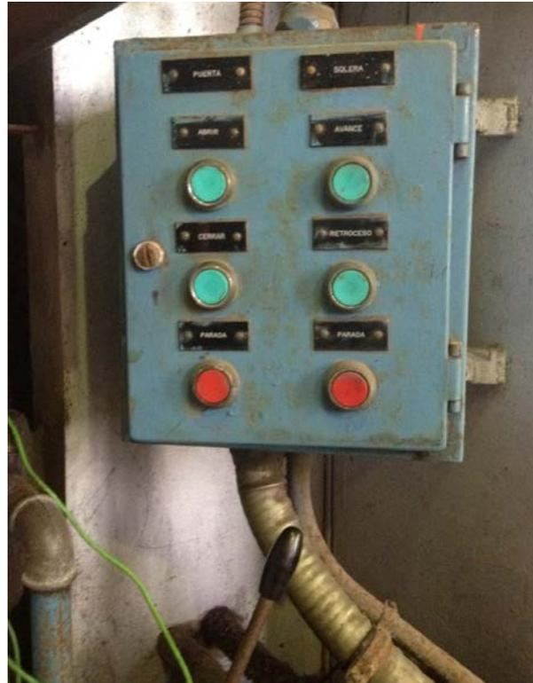
**Figura 70. Botonera control de la puerta y señalizado de la palanca que ejecutan los cilindros neumáticos.**
