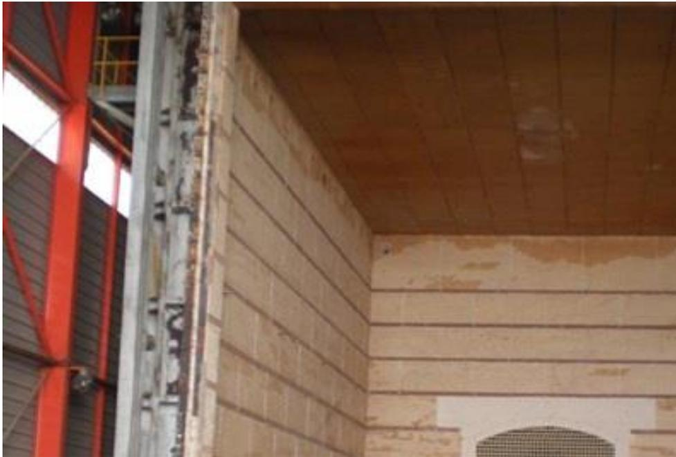
**Figura 60. Refractario lateral y superior del horno. Fuente: ENSA**
