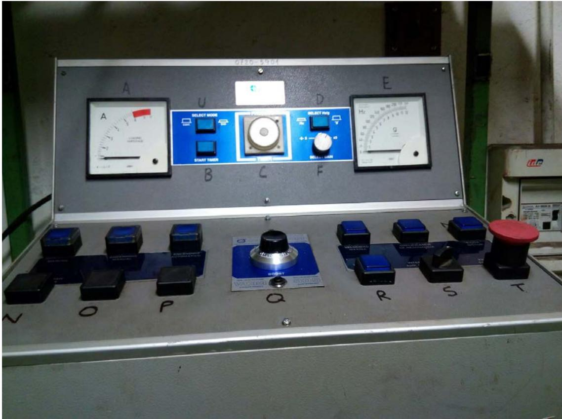
Figura 81. Máquina VCM 905 (Distensionado por vibraciones). Fuente: ENSA
