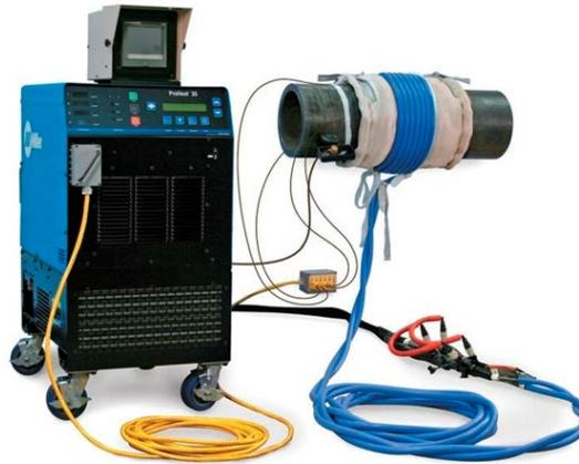
**Figura 37. Transformador de inducción. Fuente: Miller**
