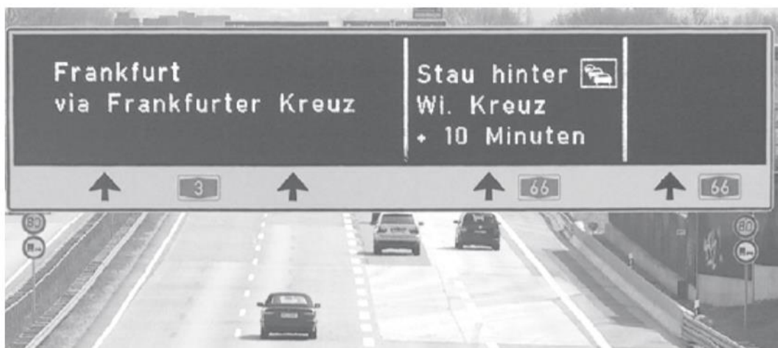
Figura 8: Panel VMS en Alemania con información de reenrutamiento y congestión. (Fuente: Active Traffic Management: The Next Step in Congestion Management).
