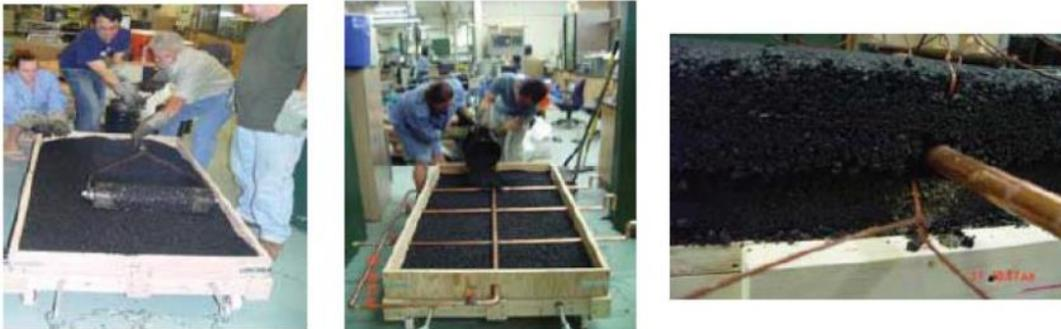
**Figura 10.** Proceso de compactación de los colectores asfálticos fabricados por Mallick et al. (2008) (*Fuente: Análisis de sistemas de captación de energía solar mediante superficies asfálticas, Chile 2014*).
