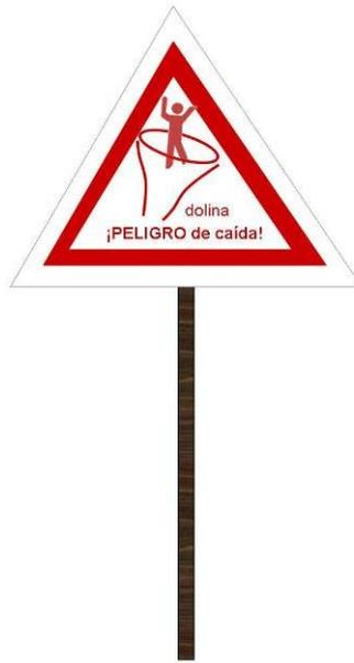
Figura 5.13.- Ejemplo de cartel a colocar cerca de las dolinas para indicar la presencia de las mismas y el posible peligro al acercarse demasiado.
