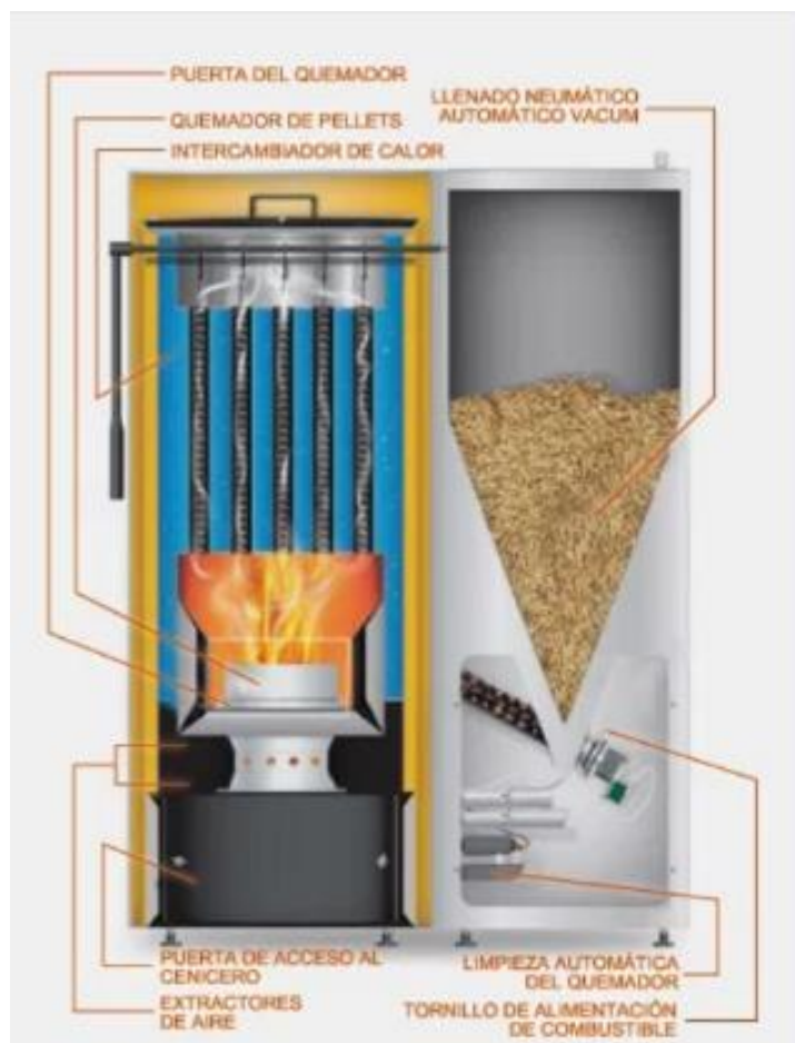
Ilustración 18: caldera de biomasa
