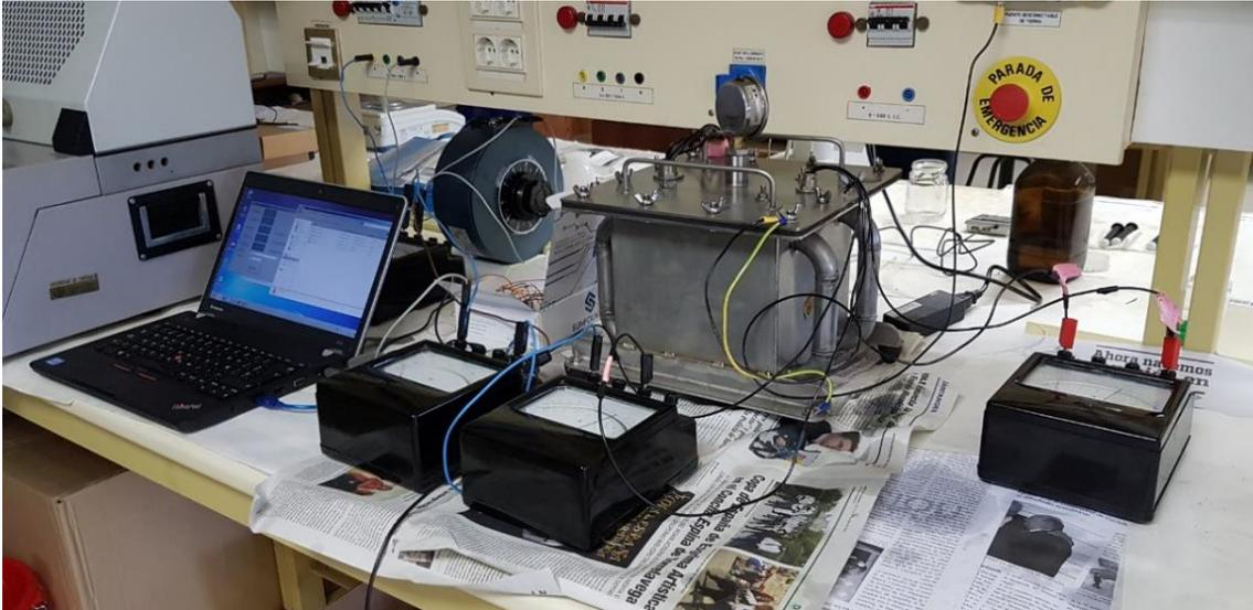
Figura 9.1. Vista de los elementos que forman la plataforma experimental: transformador en el interior de la cuba, autotransformador, equipos eléctricos de medida y el sistema informático de captación de datos.
