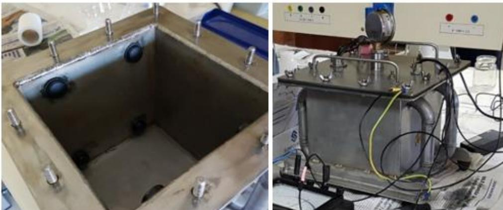
Figura 9.4. A la izquierda, orificios taponados de los radiadores. A la derecha, conjunto de transformador y cuba en su forma final
