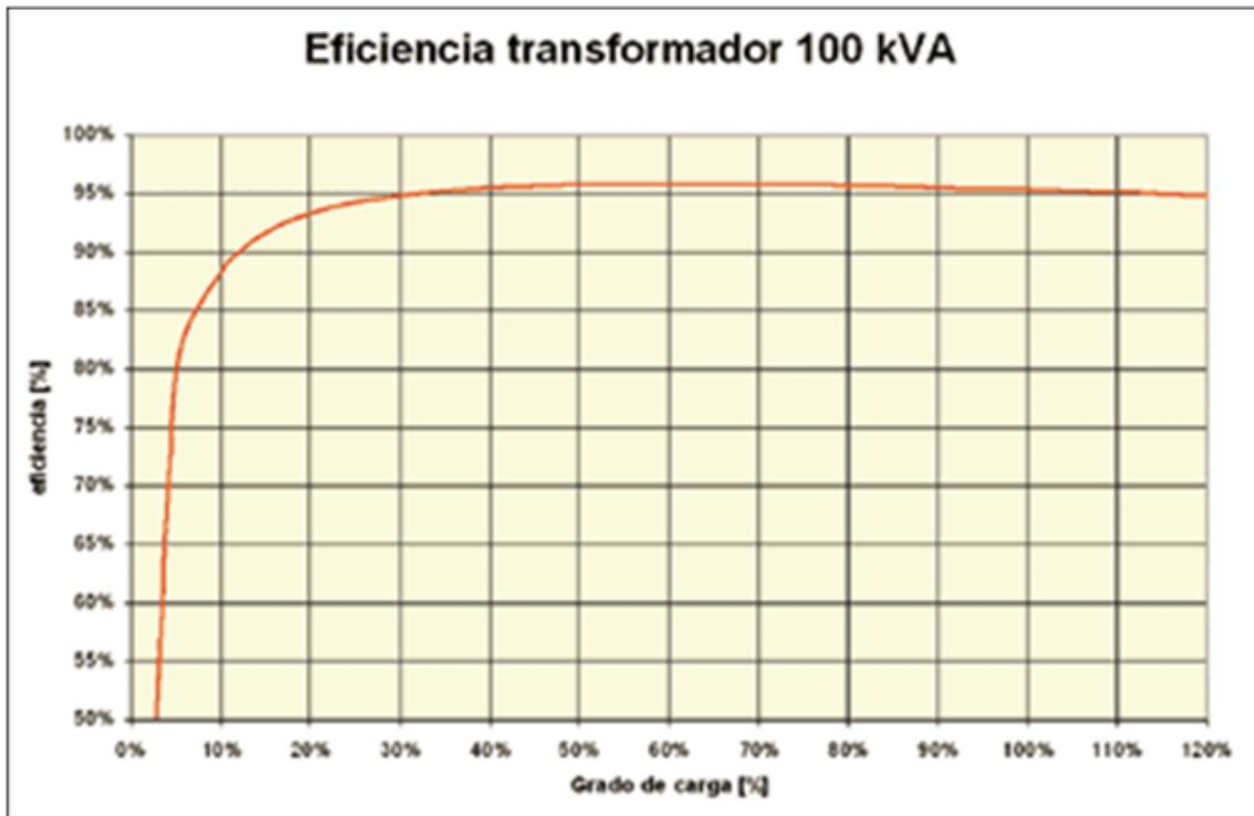
Figura 3.5. Eficiencia de un transformador
