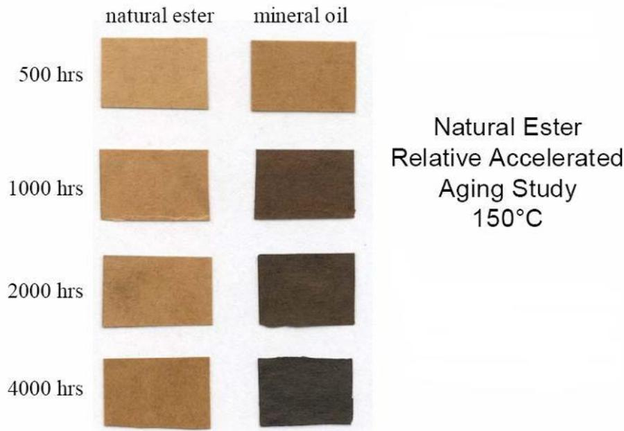
Figura 1.1. Diferencia de degradación en el papel aislante para éster natural (izq.) y aceite mineral (der.)
