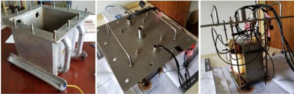
Figura 9.3. De izquierda a derecha: Vista de la cuba contenedora de aceite, vista de la tapa de la cuba y vista lateral del transformador anclado a la tapa.
