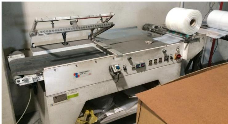
*Figura 1.12 Máquina cortadora/selladora térmica de plástico.*
