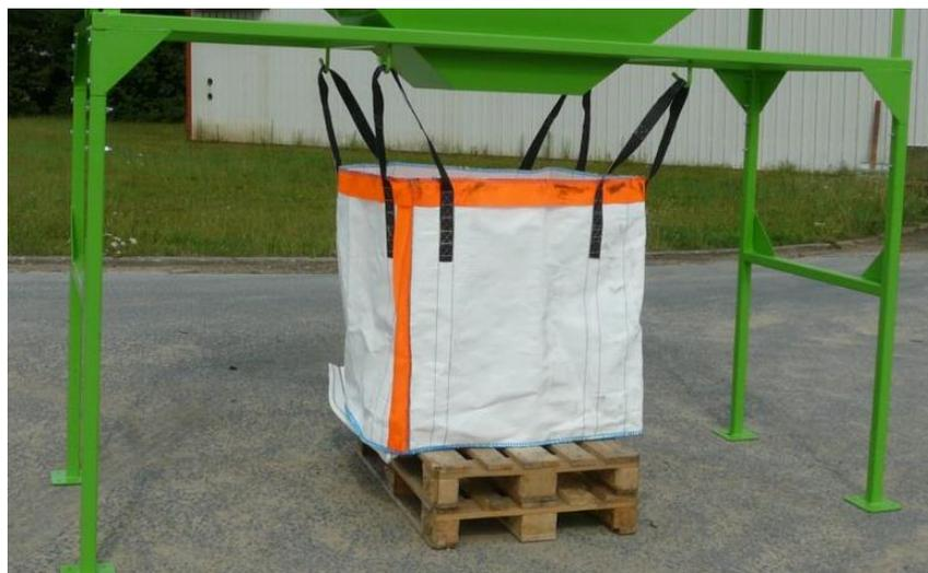
*Figura 1.19 Sistema de elevación para tolvas*
