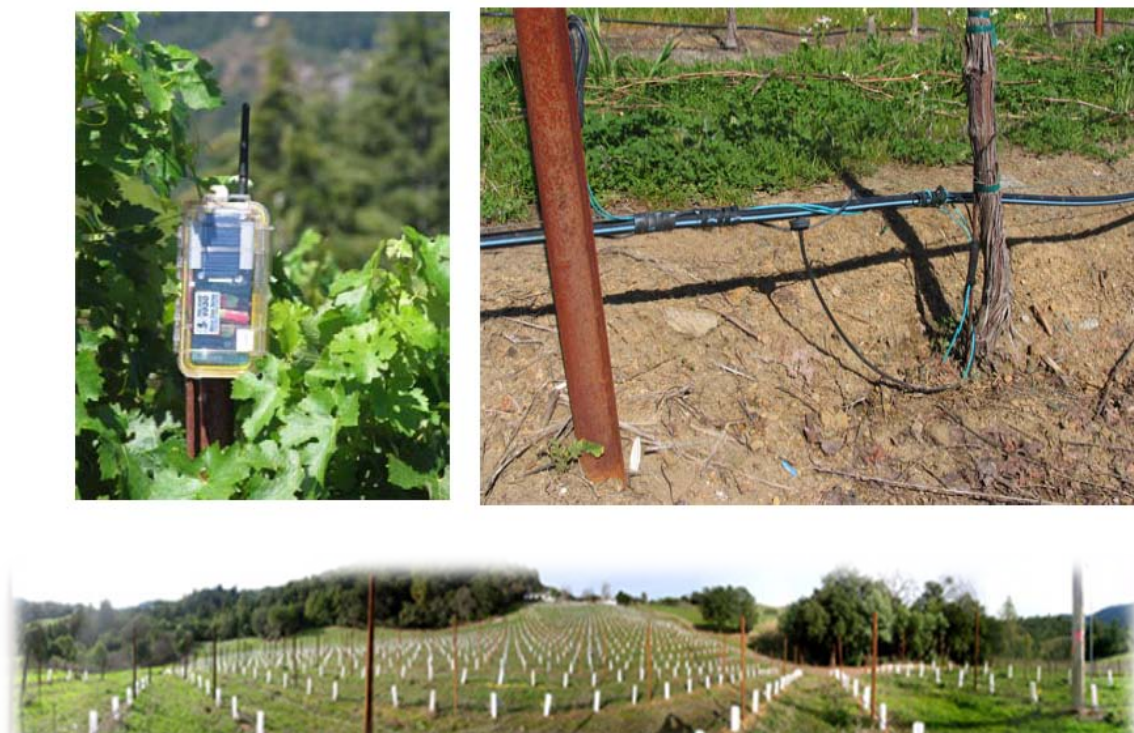
Figura 3. Nodos implantados para la monitorización de los viñedos.
