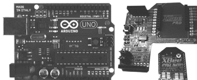
Figura 25. Arduino, XBee shield and modulo XBee
