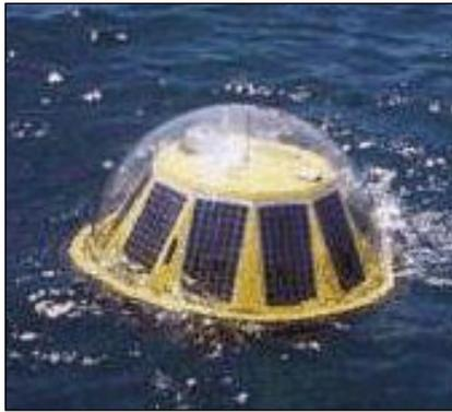
**Figura 3.2.8.2** (Obtenida de la página Web de puertos del estado, [www.puertos.es](http://www.puertos.es)). **Boya TRIAXYS:** Boya de forma esférica de 91cm de diámetro. Dispone de un sensor de temperatura del agua, acelerómetros de estado sólido, un giróscopo piezoeléctrico y un compás controlado por microprocesador. La señal se transmite vía radio a un receptor digital en tierra.
