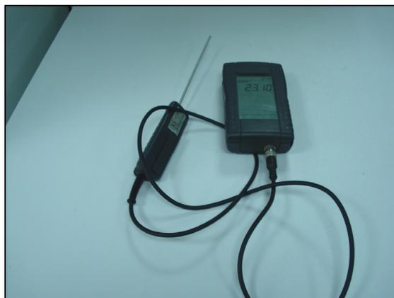
**Figura 3.2.8.1.** Termómetro digital empleado en la medición de las temperaturas *in situ*.
