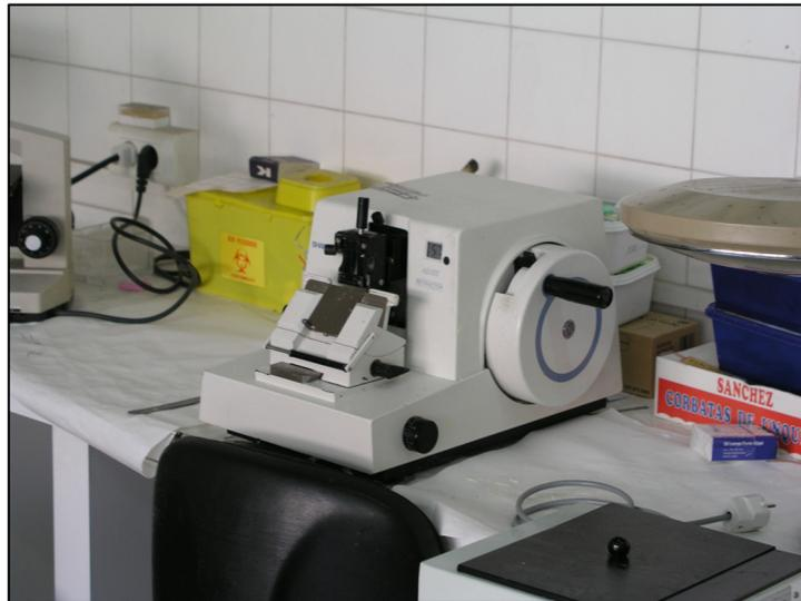
**Figura 3.2.4.2.** Micrótopo de la casa SHANDON modelo AS325 empleado en la realización de los cortes histológicos.
