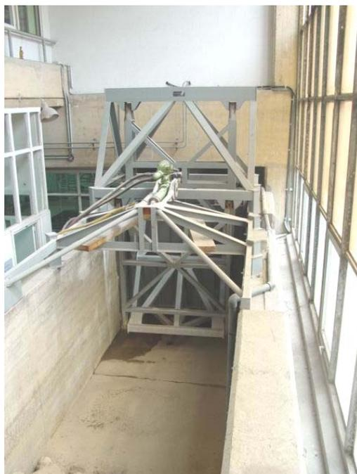
*Figura 5.3. Zona de generación del oleaje y estructura de sustentación del pistón - pala generadora.*
