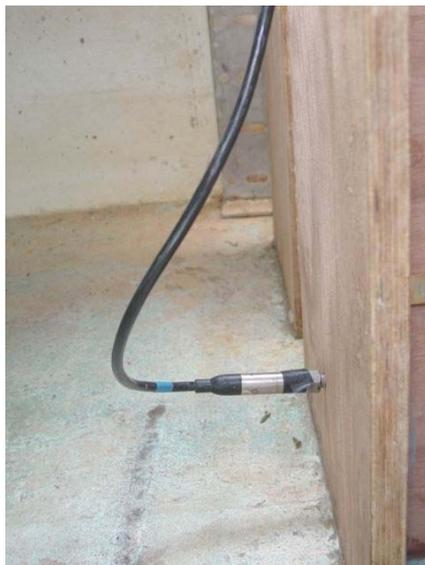
*Figura 5.6 Colocación de los sensores de presión modelo PCR830*
