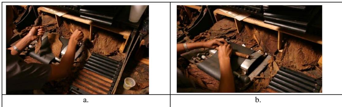
Figura 23.a. Relleno del tirulo con tripa. b. Colocación del capote. [Fuente: Fábrica T]
