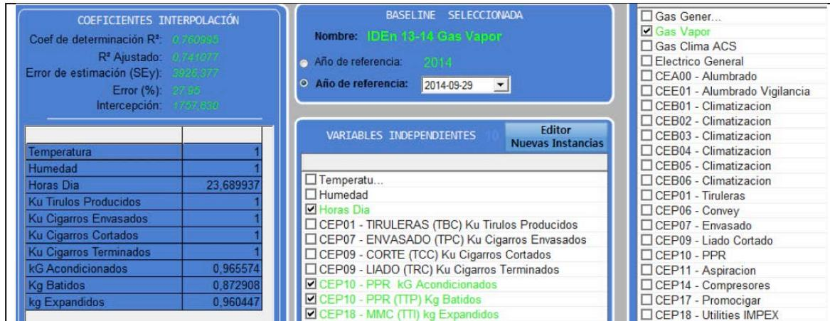
Figura 62. Parámetros estadísticos del modelo de regresión de vapor consumo térmico en el programa SCADA. [Fuente: Fábrica T.]
