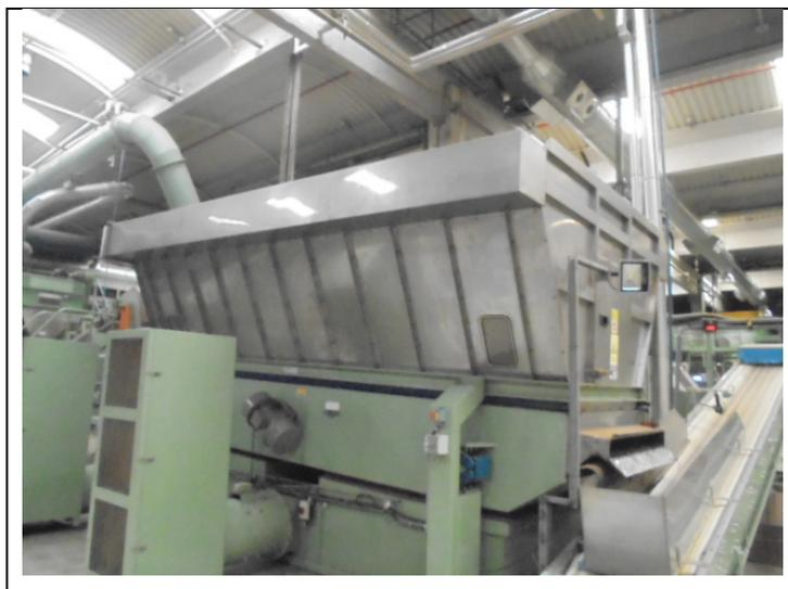
Figura 33. Secador de la tripa de tabaco. [Fuente: Elaboración propia]
