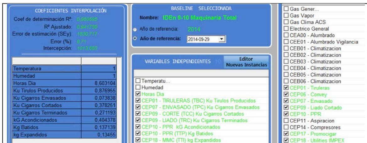
Figura 60. Parámetros estadísticos del modelo de regresión de máquinas productivas en el programa SCADA. [Fuente: Fábrica T.]
