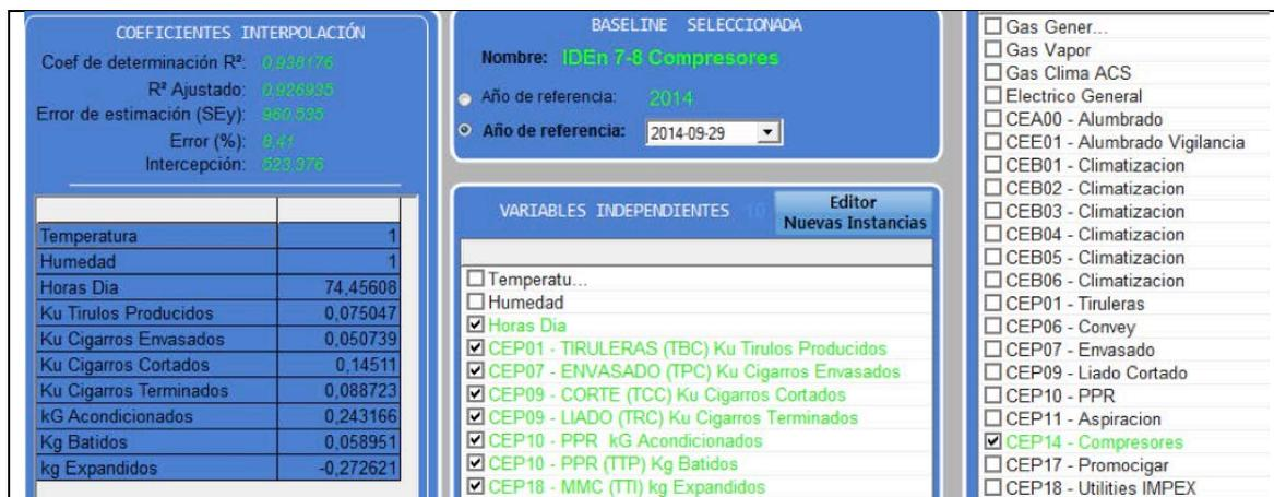
Figura 59. Parámetros estadísticos del modelo de regresión de aire comprimido en el programada SCADA. [Fuente: Fábrica T.]
