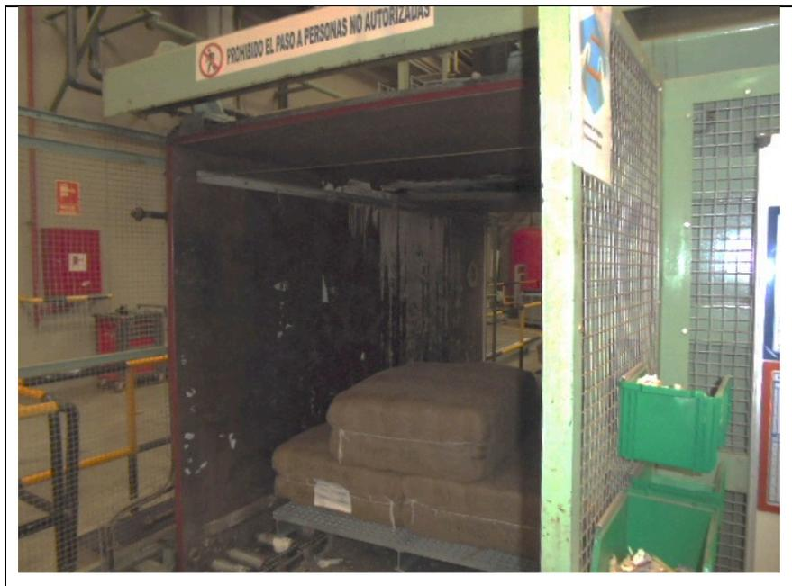
Figura 30. Cámara de Preacondicionamiento o vacío. [Fuente: Elaboración propia]
