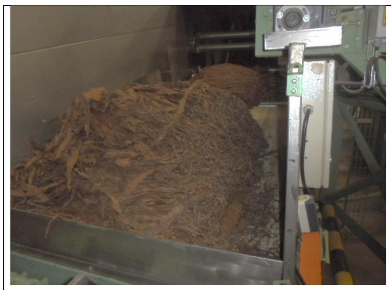
Figura 31. Alimentador de tabaco. [Fuente: Elaboración propia]
