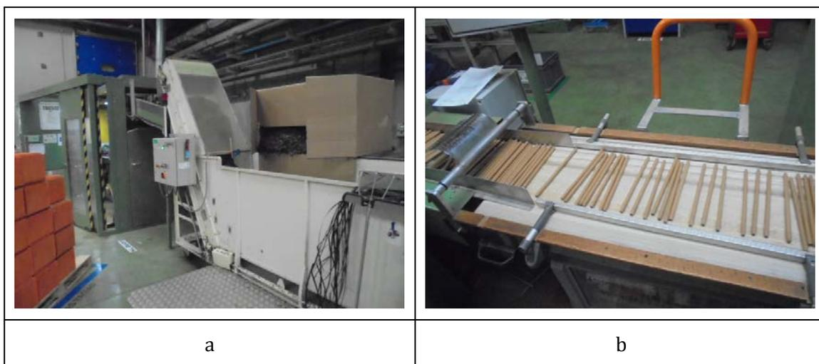
Figura 44. a. Fotografía general de una máquina tirulera donde se puede ver el abastecimiento de la tripa de tabaco. b. Salida de tirulos de la máquina. [Fuente: Elaboración propia]
