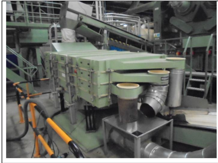
Figura 32. Tamizador compuesto por tres mallas de diferente tamaño. [Fuente: Elaboración propia]
