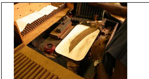
**Figura 26. Capa recortada. [Fuente: Fábrica T]**
