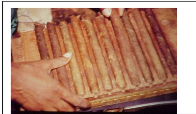
Figura 24. Prensa de tabaco. [Fuente: Fábrica T]
