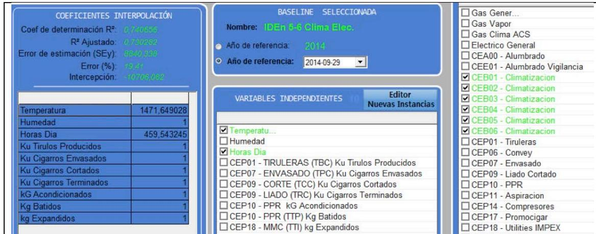
Figura 58. Parámetros estadísticos del modelo de regresión de climatización en el programa SCADA.
