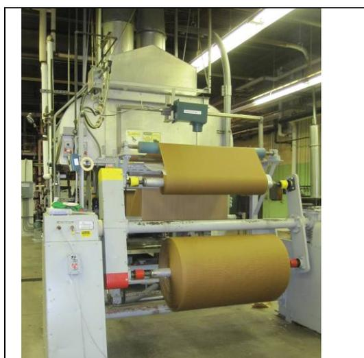
Figura 21. Bobina maestra. [Fuente: Fábrica T]
