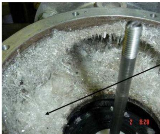
Figura IV.10: Cristalización del naftaleno en un motor a gas
