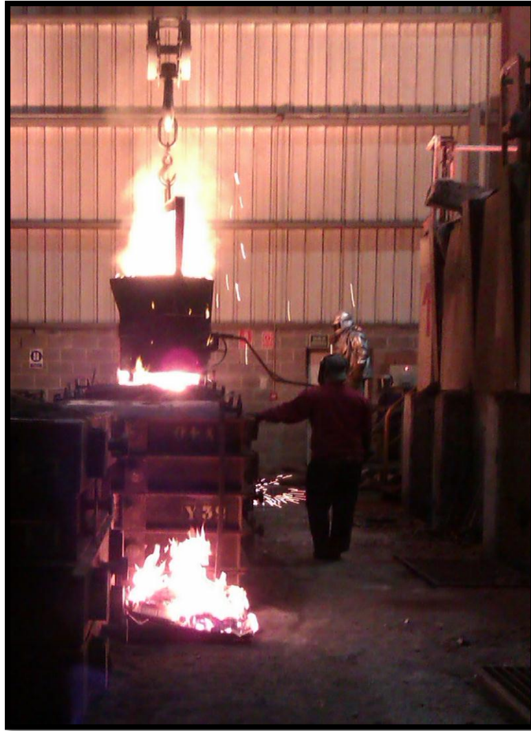
Figura 15: Trasvase de la cuchara al molde de arena.
