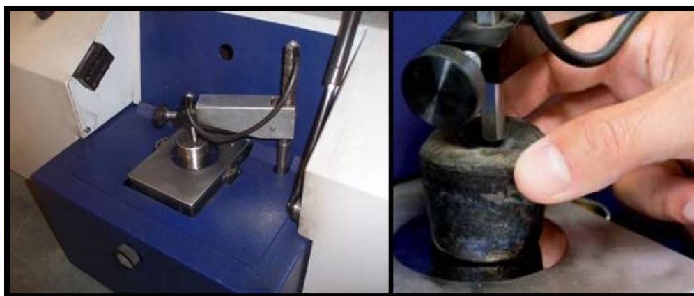
Figura 33: Espectrómetro de chispa o arco.
