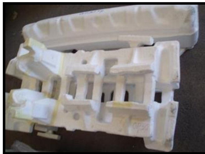
Figura 17: Esquema del proceso a la espuma perdida.
