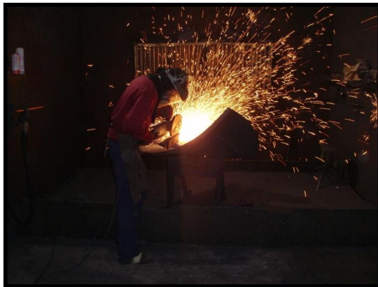
Figura 28: Desbarbado de una pieza.
