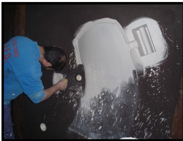
Figura 23: Pintado del molde una vez retirado el modelo.
