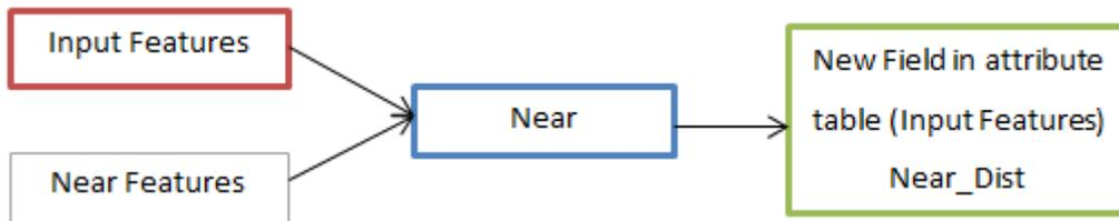
Ilustración 24: Diagrama de flujo herramienta Near
