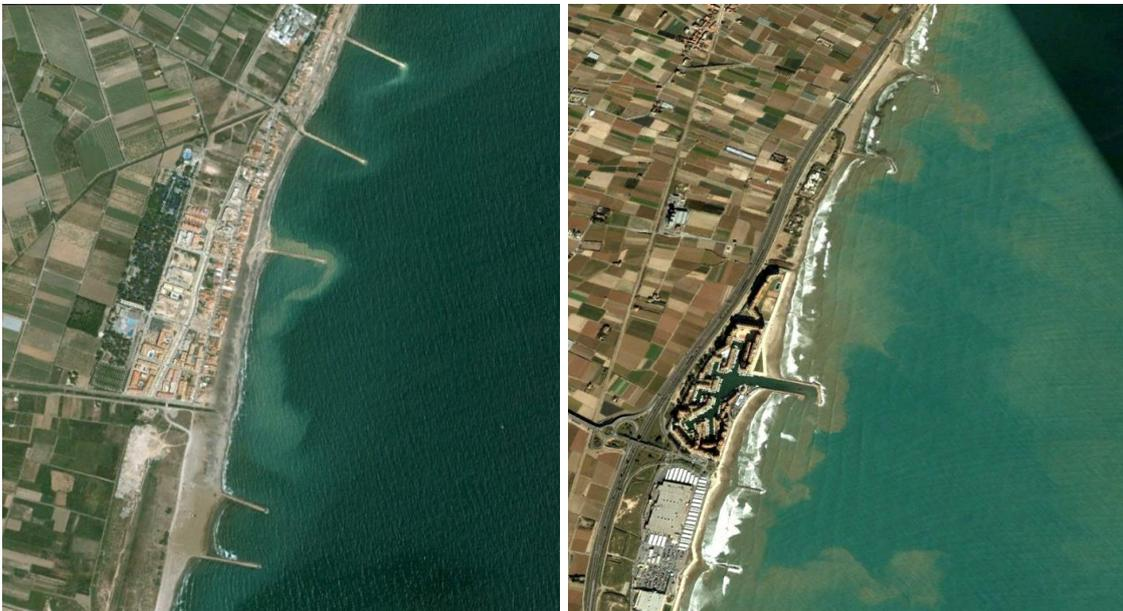
*Figura 1: Bypass en espigones al sur del puerto de Sagunto (izquierda) y Valencia (derecha)*
