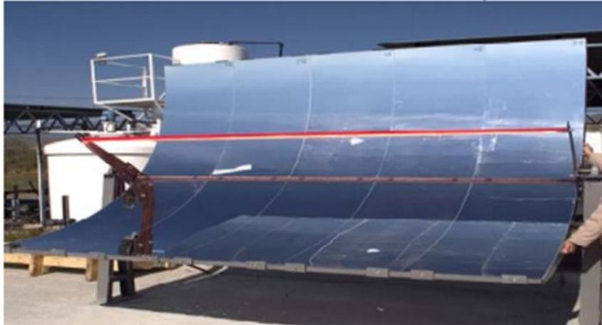
Para poder realizar los cálculos, fue necesario elegir un tipo de placa en concreto, en este caso se eligió y se trabajó con el correspondiente a la imagen 6.13, correspondiente a la placa solar PTC 1000 - Modular parabolic trough collector puesto que, aunque en ambos casos el precio por metro cuadrado era el mismo, en el primero las medidas eran más acorde al espacio que se disponía.
