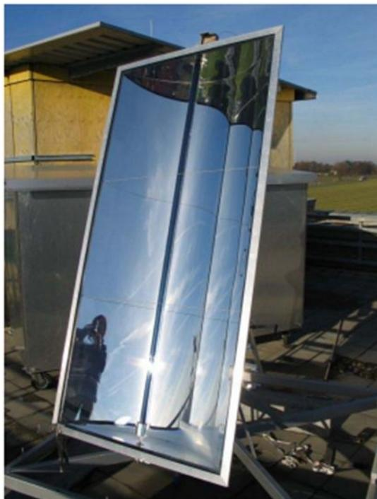
2. El segundo ejemplo sería el FASOL (Imagen 6.14), El diseño inicial del colector FASOL fue basado en el uso de espejos de vidrio delgado (1,2 mm de espesor) como reflectores en una estructura parabólica compuesta.
