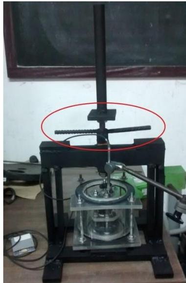
*Figura 5.17. Mecanismo de giro con biela*
