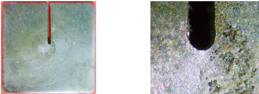
**Figura 6.13.** Macrografía general y detalle de la probeta SPT del acero X80 ensayada bajo 366 N en ambiente de polarización catódica de 5 mA/cm<sup>2</sup>.
