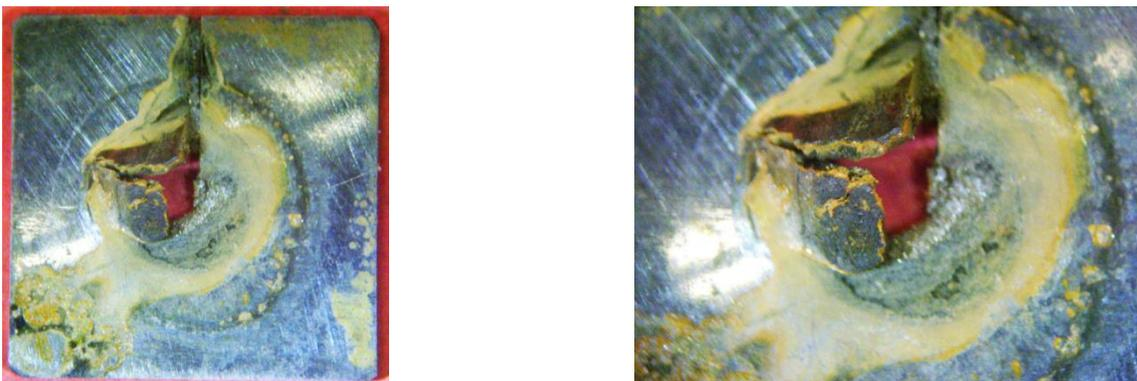
**Figura 6.7.** Macrografía general y detalle de la probeta SPT del acero Cr-Ni-Mn ensayada bajo 405 N en ambiente de polarización catódica de 5 mA/cm<sup>2</sup>.
