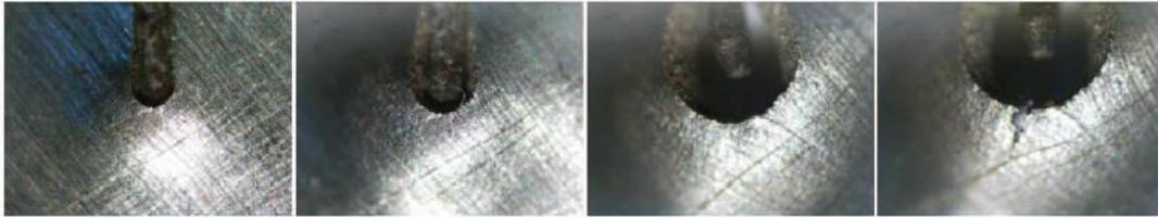
**Figura 4.8.** Evolución del enromamiento en el fondo de la fisura durante un ensayo hasta el inicio de su propagación [49].
