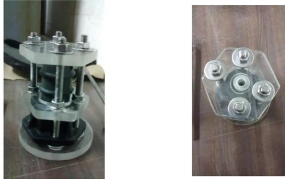
*Figuras 5.16. A) y B) Dispositivo contenedor de la probeta*
