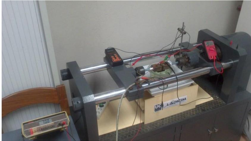
*Figura 3.3. Máquina de tracción lenta con eje horizontal durante un ensayo de CBT convencional del LADICIM.*
