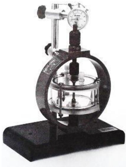
*Figura 3.1. Dispositivo de ensayo de corrosión bajo tensión usando un anillo de prueba de carga [2].*
