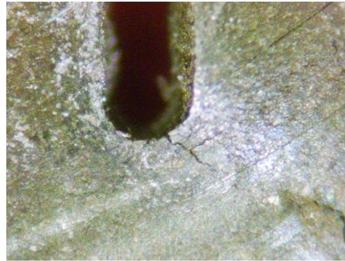
**Figura 6.16.** Macrografía general y detalle de la probeta SPT del acero S420 ensayada bajo 344 N en ambiente de polarización catódica de 5 mA/cm<sup>2</sup>.
