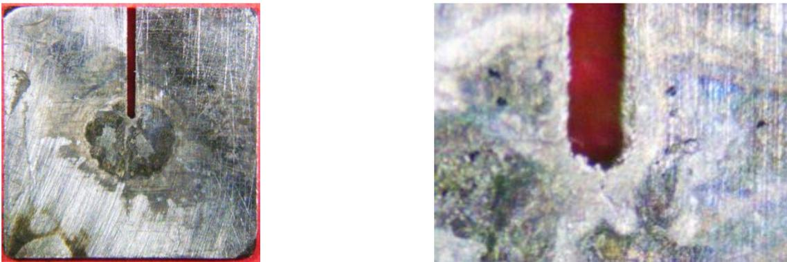
**Figura 6.9.** Macrografía general y detalle de la probeta SPT del acero Cr-Ni-Mn ensayada bajo 268 N en ambiente de polarización catódica de 5 mA/cm<sup>2</sup>.
