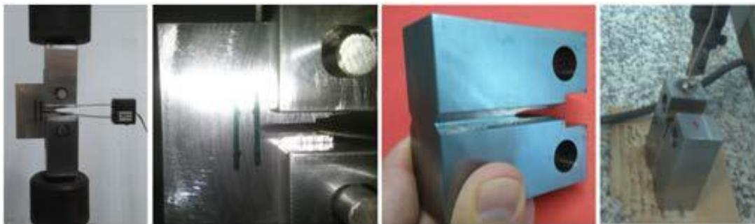
**Figura 5.9.** Operaciones a realizar previas al ensayo.
