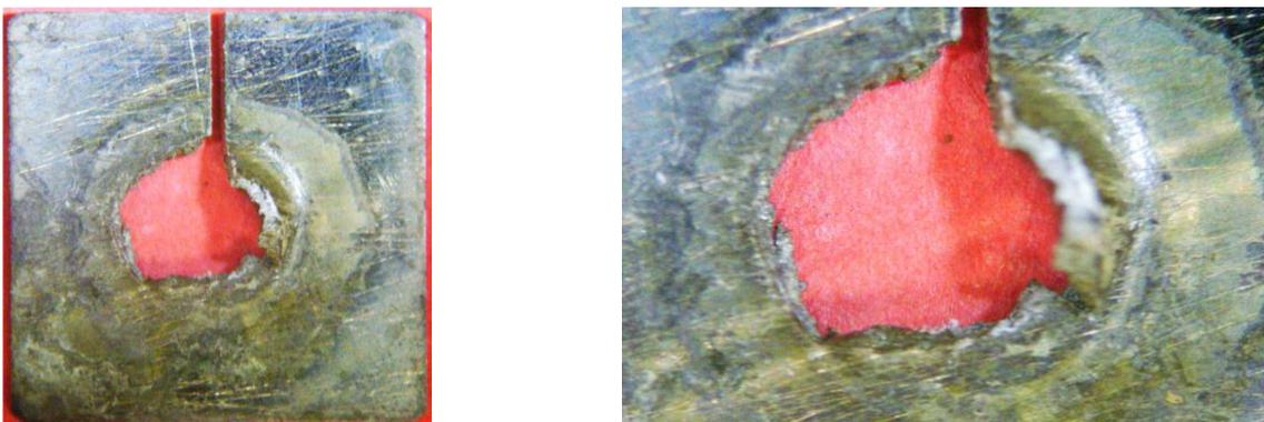
*Figura 6.5. Macrografía general y detalle de la probeta SPT del acero Cr-Ni-Mn ensayada bajo 572 N en ambiente de polarización catódica de 5 mA/cm<sup>2</sup>.*
