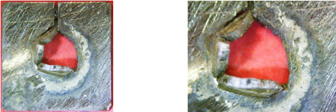
**Figura 6.6.** Macrografía general y detalle de la probeta SPT del acero Cr-Ni-Mn ensayada bajo 479 N en ambiente de polarización catódica de 5 mA/cm<sup>2</sup>.
