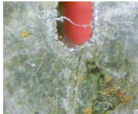
**Figura 6.17.** Macrografía general y detalle de la probeta SPT del acero S420 ensayada bajo 325 N en ambiente de polarización catódica de 5 mA/cm<sup>2</sup>.
