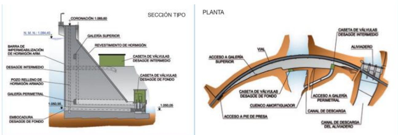
Figura 2: Esquema de la presa vista de perfil y de planta. [3]
