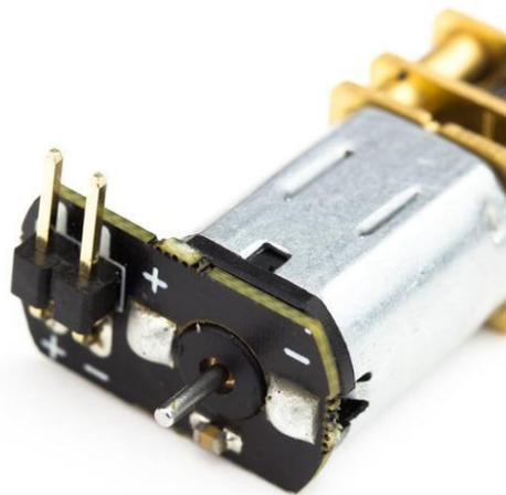
**Figura 6: Imagen del Micro Metal Gearmotor junto con el Push Header Shim para su conexión al Explorer Phat**
