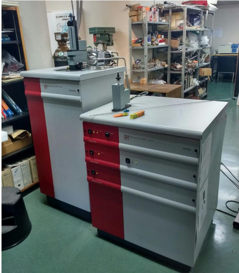
Figura 2.3: Magnetómetro Quantum Design MPMS XL 5T en los laboratorios del CITIMAC en la Facultad de Ciencias de la UC.
