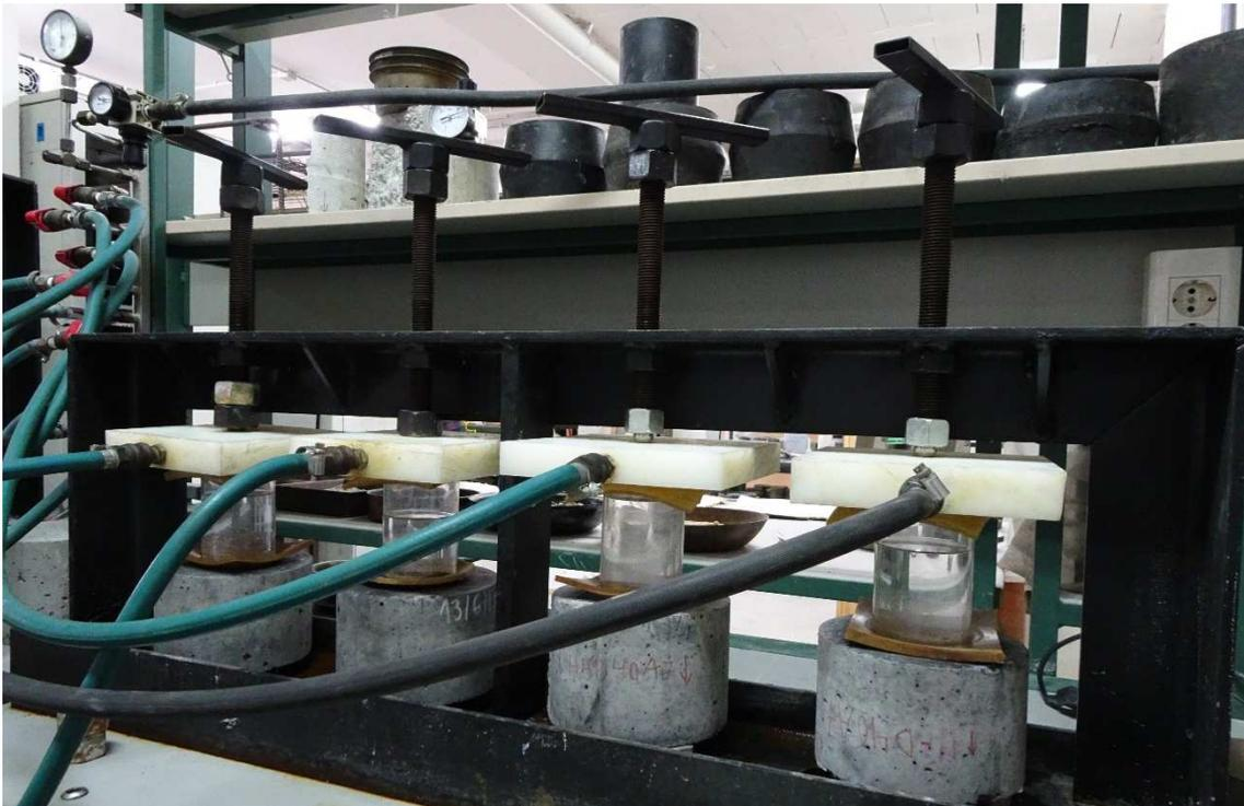
Fig. 21. Equipo para el ensayo de permeabilidad al agua a presión.
