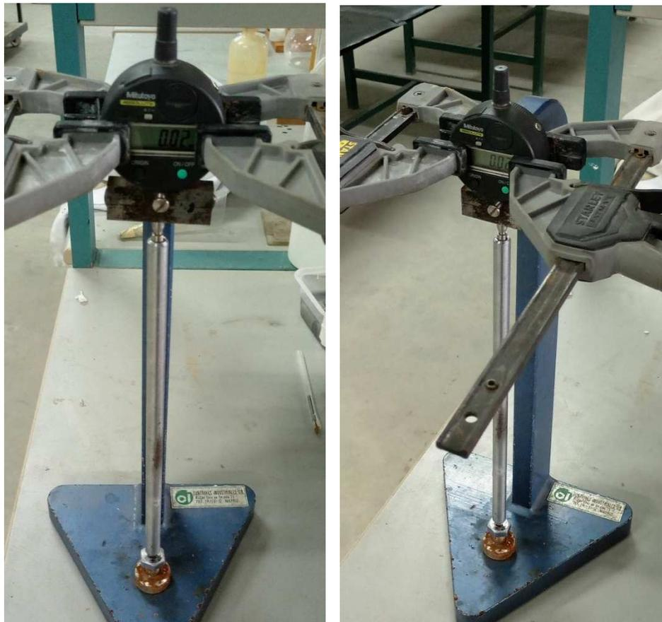
Fig. 22. Equipo utilizado para la medición de la retracción.
