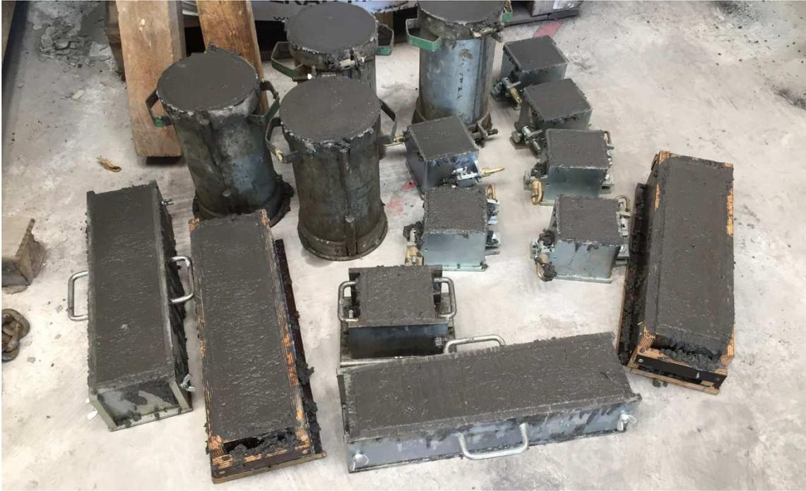
*Fig. 15. Probetas con hormigón en estado fresco.*
