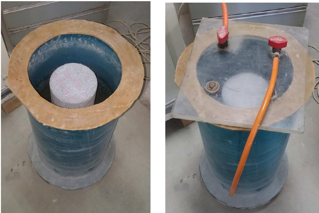
Fig. 19. Tanque de vacío para la determinación de las propiedades físicas.
