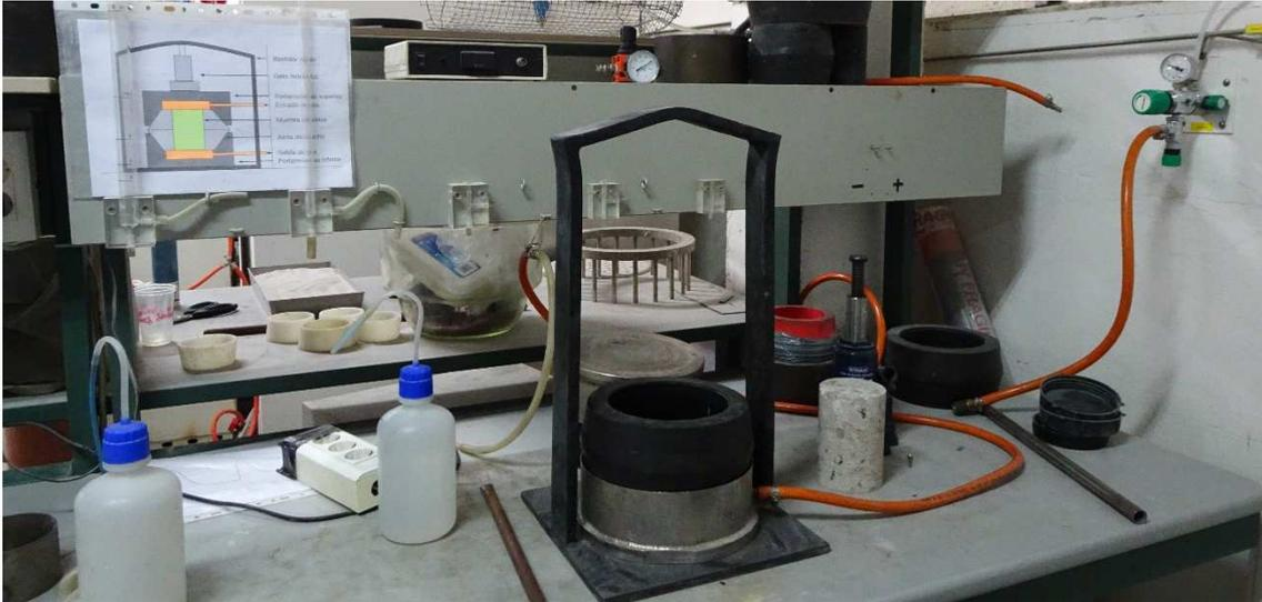
Fig. 20. Equipo para la determinación de la permeabilidad al oxígeno.
