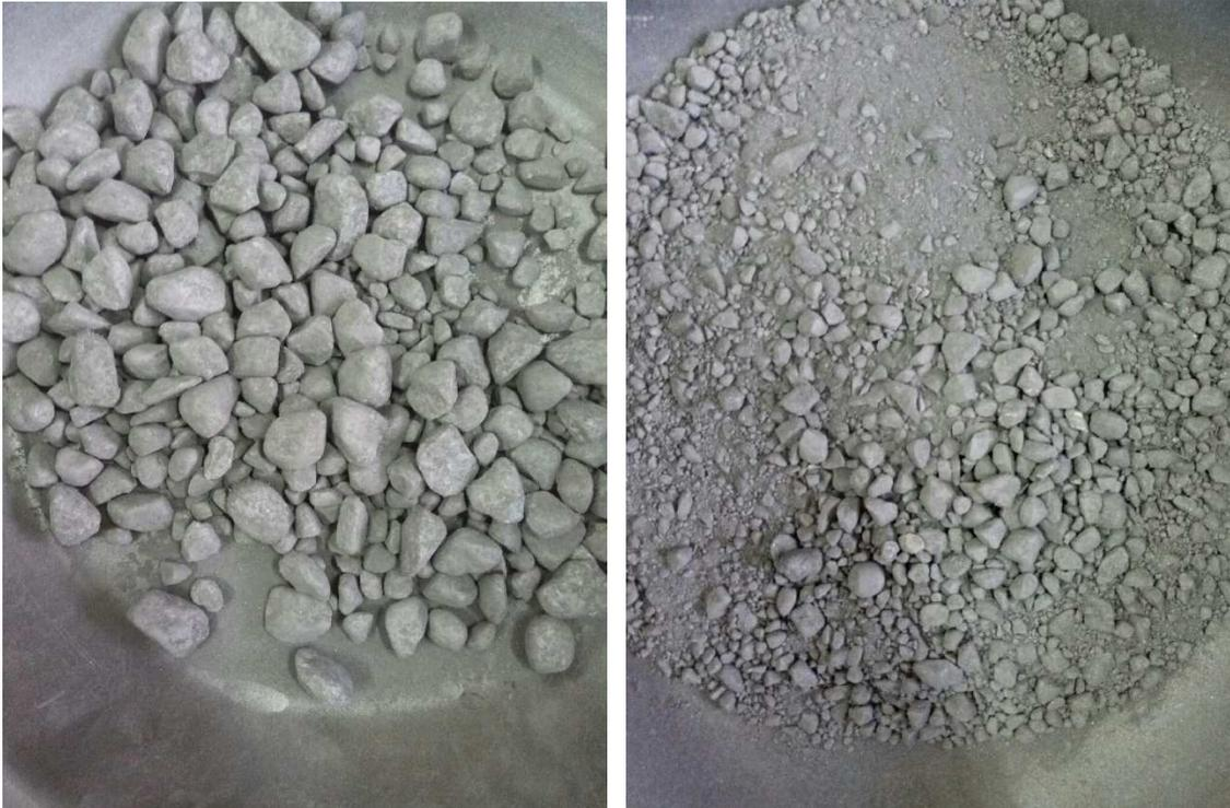
Fig. 7. Detalle de los áridos empleados. A la izda. La grava (0/20), a la derecha la gravilla (0/8).
