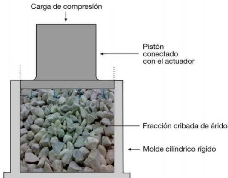
Fig. 9. Representación esquemática del ensayo de machacabilidad.
