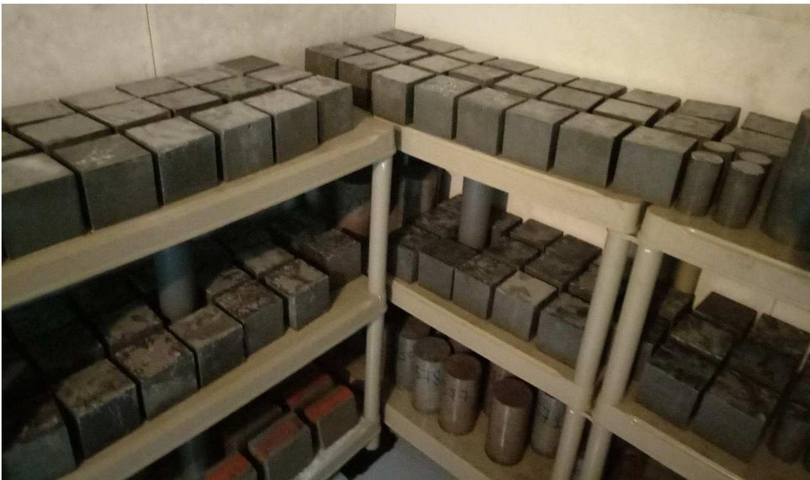
Fig. 18. Cámara de curado con control de humedad y temperatura.
