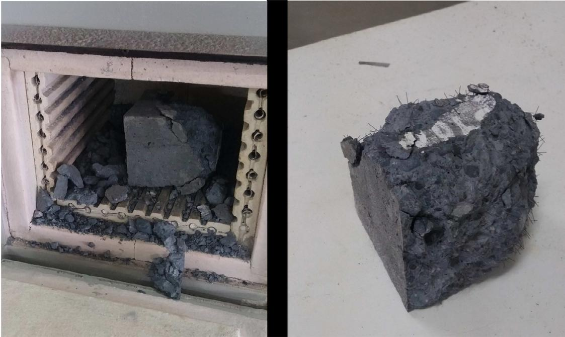
Fig. 57. Spalling explosivo a 250 °C.
