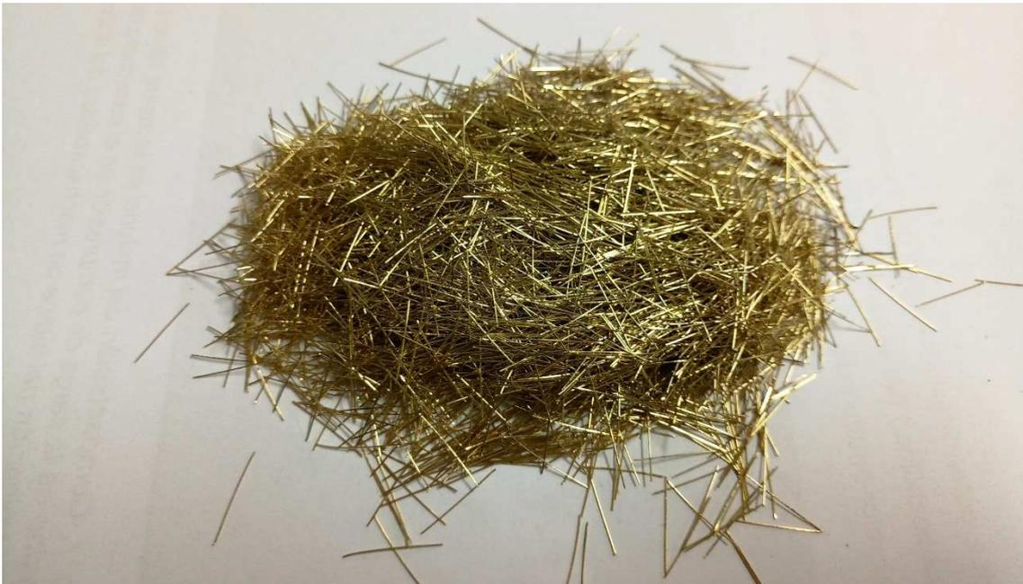
*Fig. 10. Detalle de las fibras metálicas utilizadas.*
