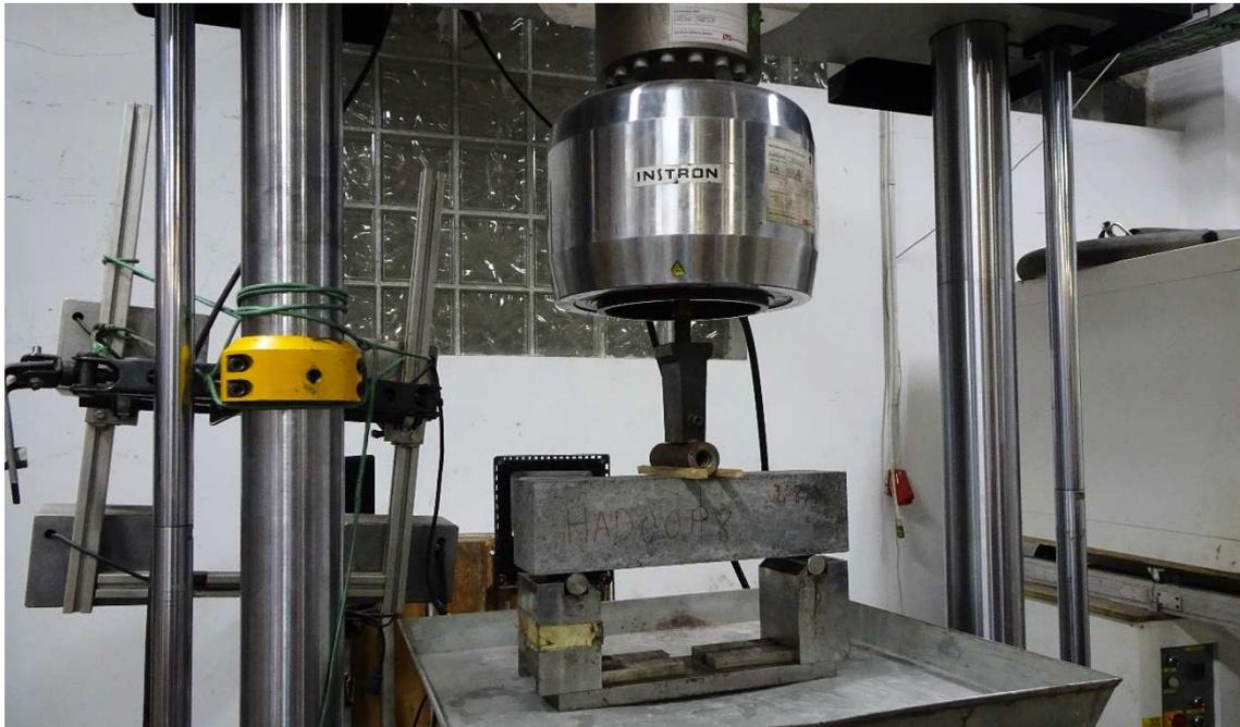
Fig. 25. Equipo para la determinación de la resistencia a flexotracción.
