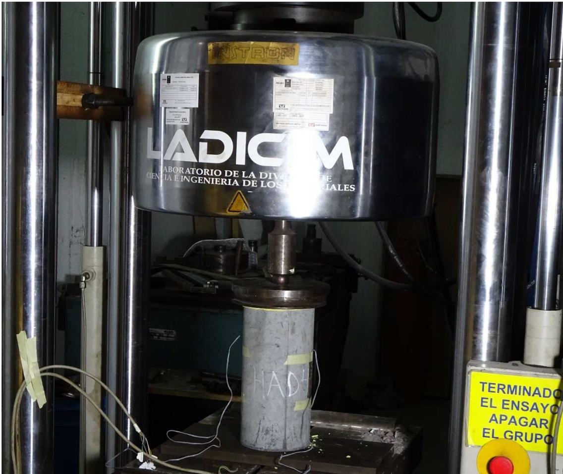
Fig. 24. Equipo para la determinación del módulo elástico.
