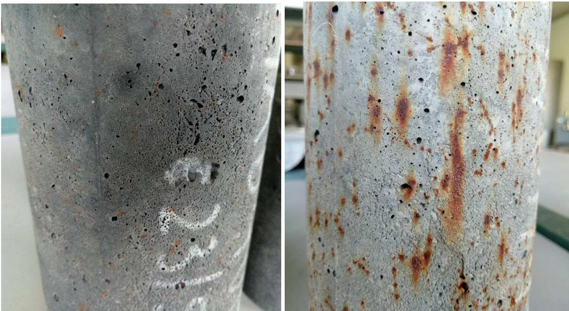
Fig. 51. Detalle de probetas sometidas a ciclos de humedad sequedad. A la izda ataque por sulfatos, a la derecha ataque por cloruros.
