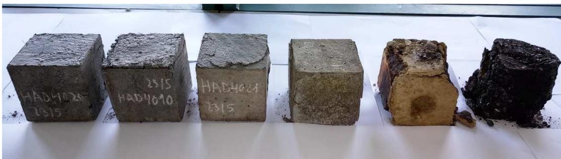
*Fig. 54. Probetas sometidas a altas temperaturas. De izda. A dcha.: 105 °C, 300 °C, 500 °C, 700 °C, 1000 °C y 1200 °C.*
