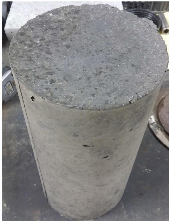
*Fig. 16. Probeta con 24 horas de edad recién desmoldada.*
