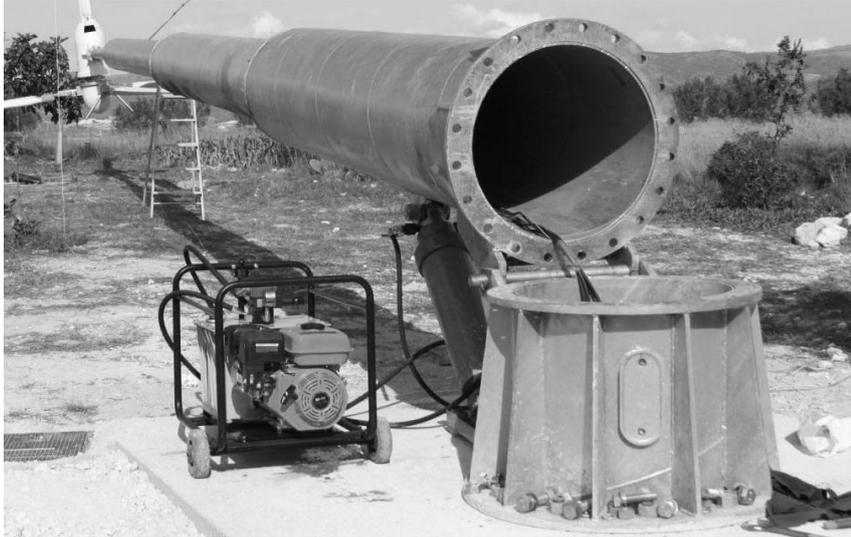
Otra de las ventajas que tiene este sistema es que se puede abatir cuando se den vientos demasiado fuertes, potencialmente peligrosos para el sistema eólico o cuando el aerogenerador vaya a estar sin producir energía durante un periodo largo de tiempo, ya sea por ausencia del propietario o por cualquier otra razón.
