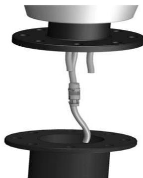
Ilustración 31, figura de la unión de los cables. Fuente Manual de usuario aerogeneradores 30 y 70 Enair
