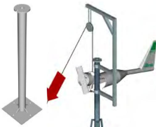
Para instalar el aerogenerador sobre la torre, necesitará un adaptador que permita que las hélices giren sin peligro de golpear la torre. Instale el aerogenerador una vez el adaptador y la torre hayan sido instalados. Puede subirlo a su posición usando la grúa después de haber erigido la torre, o bien utilizando una polea, como se muestra en la figura.
