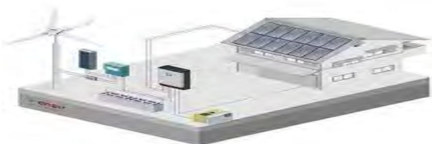
**Ilustración 16, Esquema de una instalación mini eólica**
