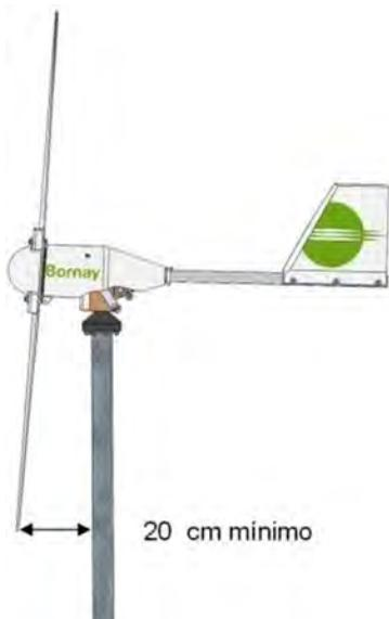
Una vez instalado el aerogenerador sobre la torre, debe de comprobarse que este es capaz de girar libremente y que no existe ningún obstáculo dentro del diámetro de las hélices.
