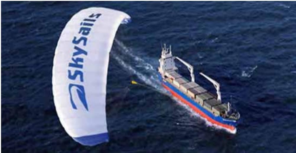
**Ilustración 1** portacontenedores con el sistema de vela SkySails
