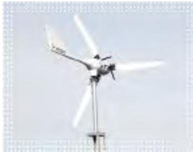
Con una velocidad de viento medio situado en la nominal de unos 10 - 12 m/s. El modelo **Enair 30** es capaz de generar hasta **30 kwh/dia**.
