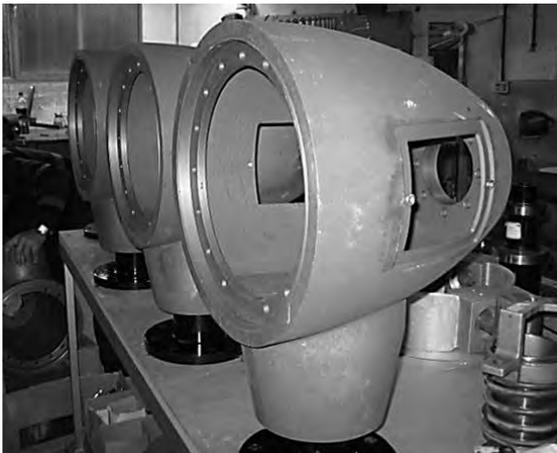
Pieza inyectada de Aluminio anodizado, que proporciona gran robustez a un peso mínimo.
