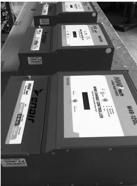
La electrónica, es uno de los principales puntos que se han evolucionado, consiguiendo obtener un regulador de carga de baterías y regulador de conexión a red que nos permiten eficiencias de entre 93% y el 97%.
