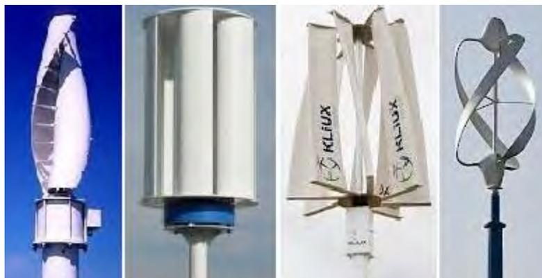
**Ilustración 8, turbinas de eje vertical Fuente <http://energias-renovables-y-limpias.blogspot.com>**
