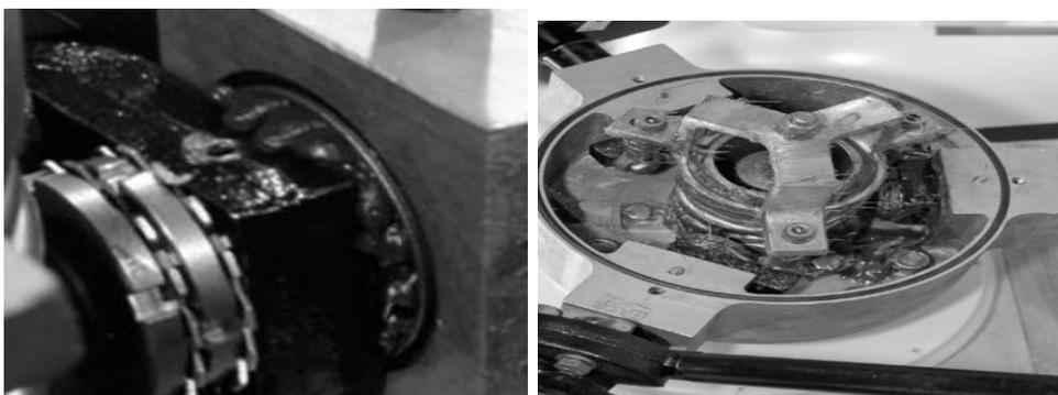
Ilustración 41, Apreciación del rebose de la grasa en la izquierda y detalle del engrasado del paso variable a la derecha. Fuente Manual de usuario aerogeneradores 30 y 70 Enair
