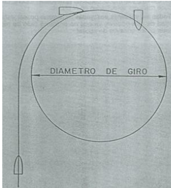
Figura 39. Círculo de evolución para determinar el diámetro de giro del buque (José Aláez, 1995)
