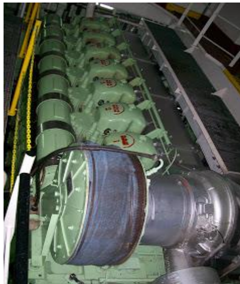
Figura 26. Motor Man 7L 32/40 con turbocompresor NR29/S061 (Carlos Rodríguez, 2016)
