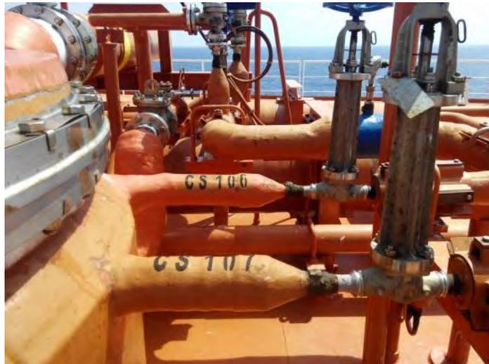
**Ilustración 127** Detalle de unión de la línea de Spray con el domo de vapor. Fuente: elaboración propia
