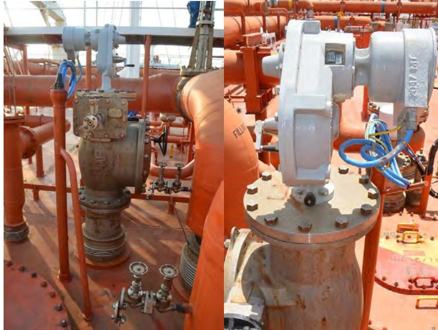
**Ilustración 99 Float Level Gauge. Fuente: elaboración propia**
