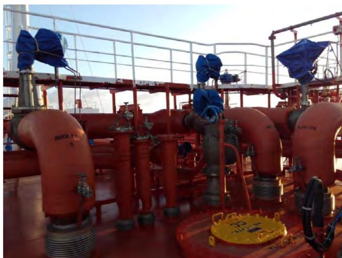
Ilustración 124 Detalle válvulas de descarga y la Branch. Fuente: elaboración propia
