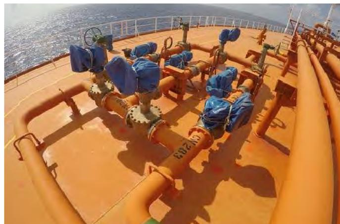
Ilustración 51 Línea de Nitrógeno con piano de válvulas de salida. Fuente: elaboración propia.
