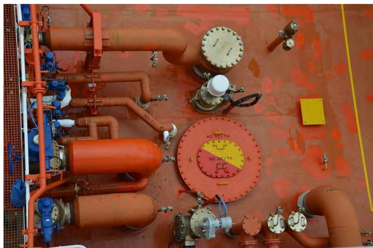
Ilustración 59 Domo de líquido con las líneas entrando en él. Fuente: elaboración propia
