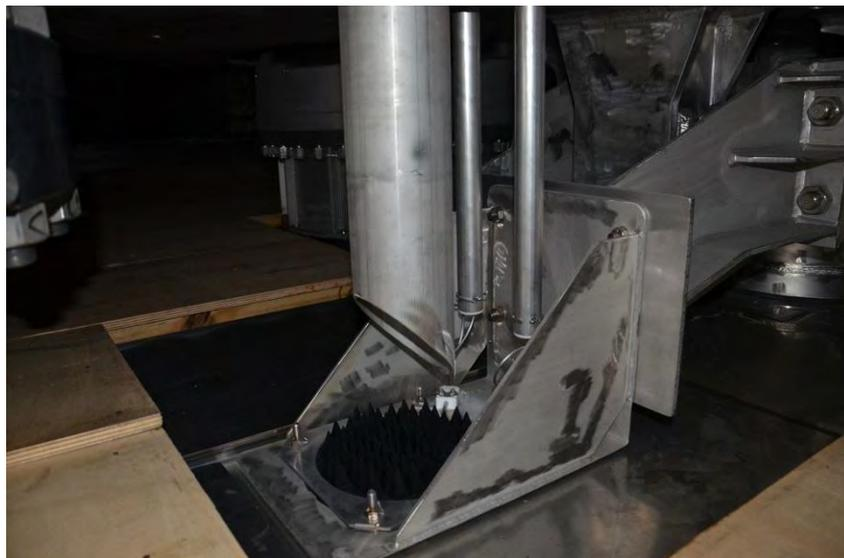
**Ilustración 98** Atenuador de la señal del radar. Fuente: elaboración propia
