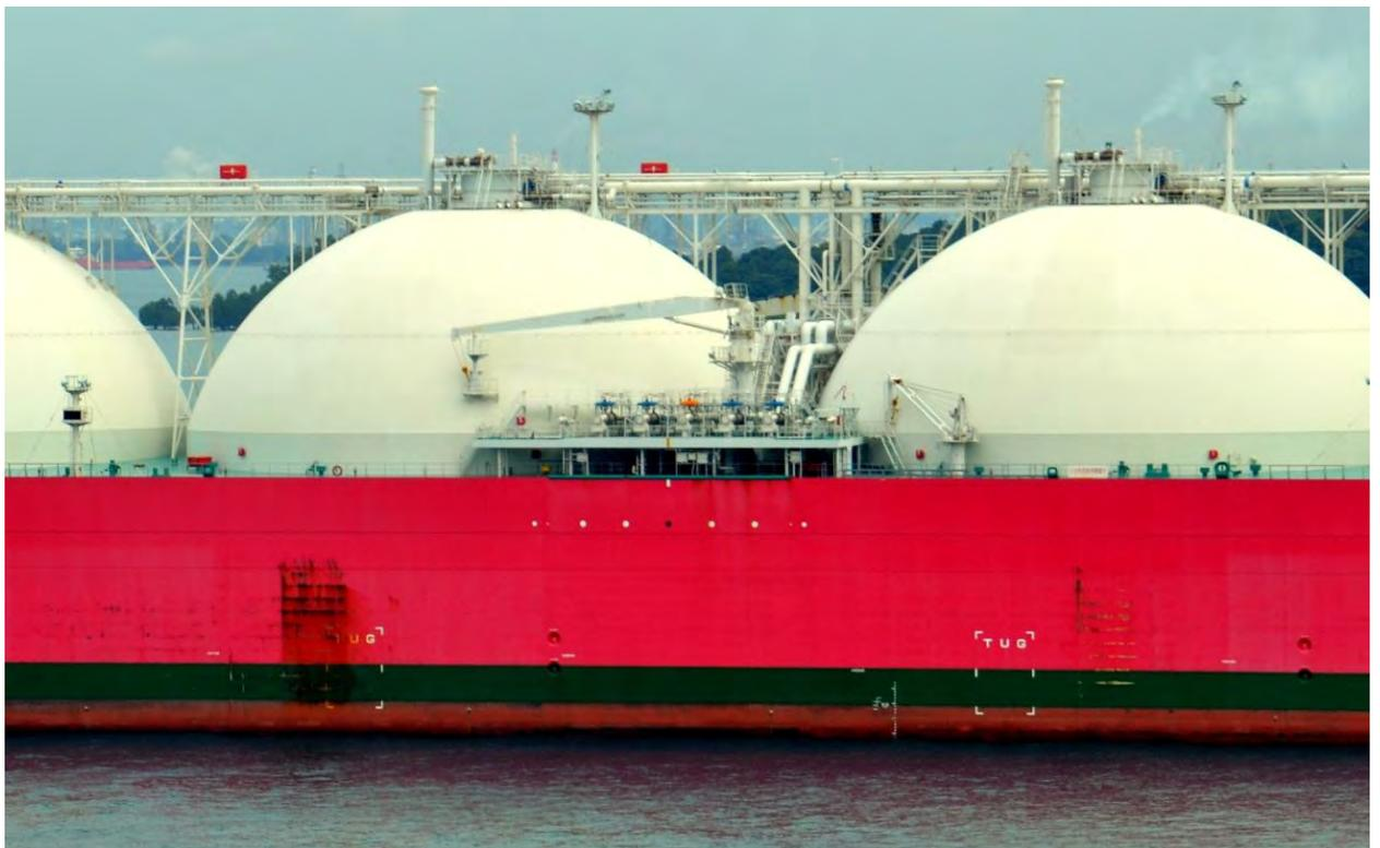
Ilustración 11 Manifold de un buque tipo Moss en Singapore. Fuente: elaboración propia
