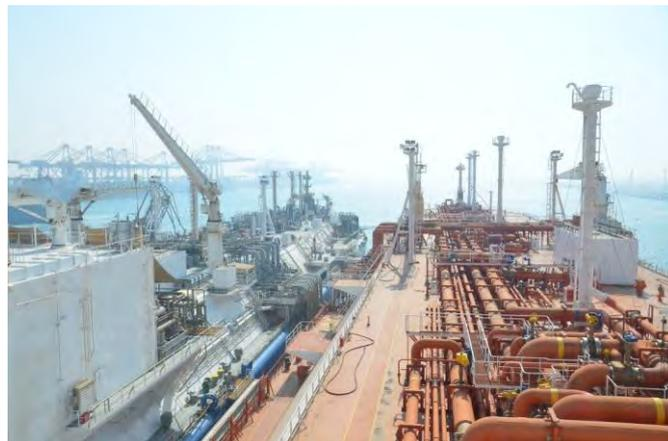
Ilustración 116 Detale de colocación de mangueras en la Tunk Deck. Fuente: elaboración propia
