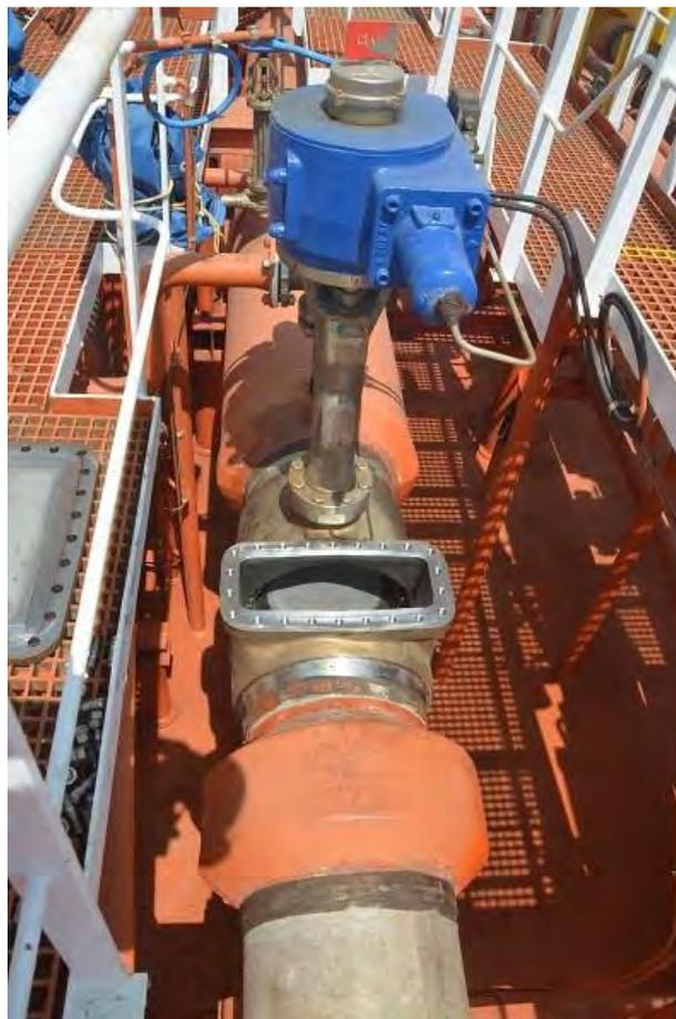
Ilustración 54 Válvula de una línea de líquido. Fuente: elaboración propia.
