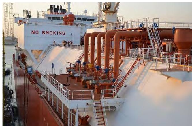
**Ilustración 37** Manifold de estribor de un buque. Fuente: elaboración propia
