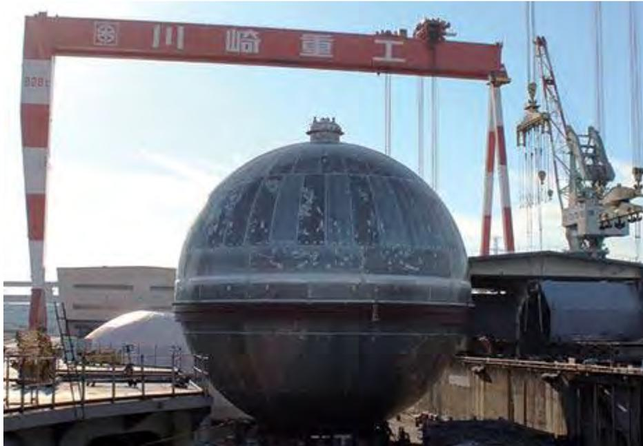
**Ilustración 7 Tanque de Carga. Fuente: Veristarnews**
