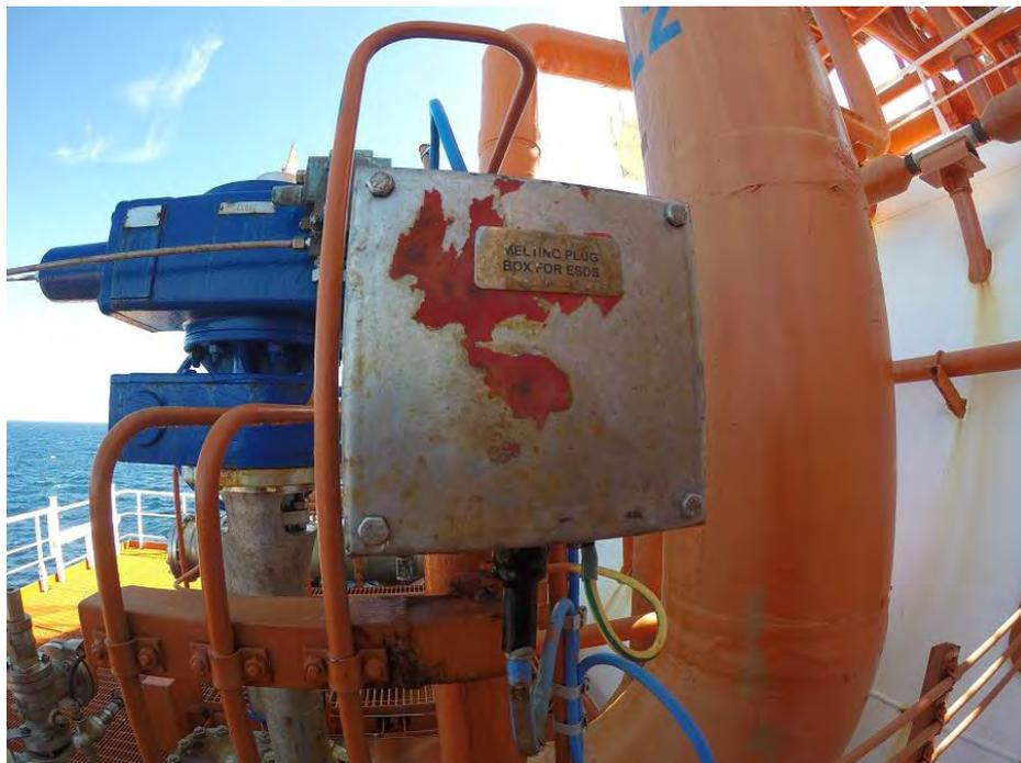
Ilustración 107 Melting Plug en un Manifold. Fuente: elaboración propia
