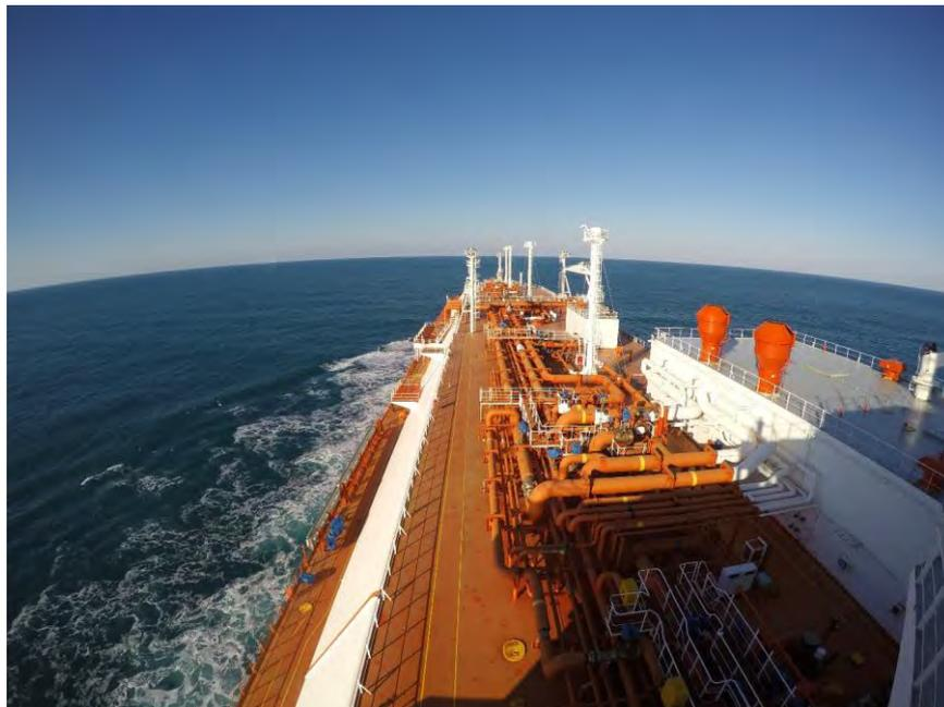
**Ilustración 40** Detalle de líneas en una Trunk Deck. También se ven los palos de venteo, los Manifolds y el cuarto de compresores. Fuente: elaboración propia
