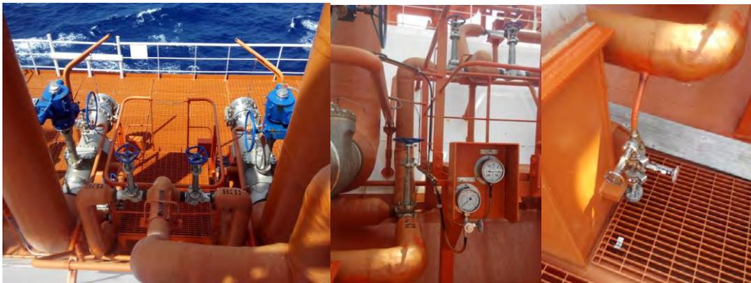
Ilustración 134 Detalle Purgado de líneas. Fuente: elaboración propia
