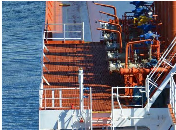
Ilustración 119 Detalle bandeja manifold. Fuente: elaboración propia
