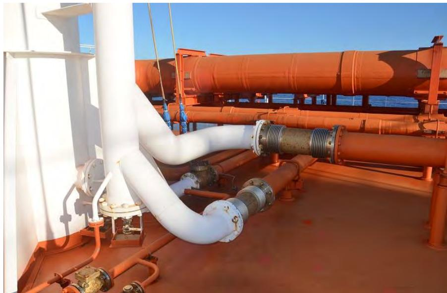
**Ilustración 43** Anillos de expansión justo antes de llegar al palo de venteo. Fuente: elaboración propia.
