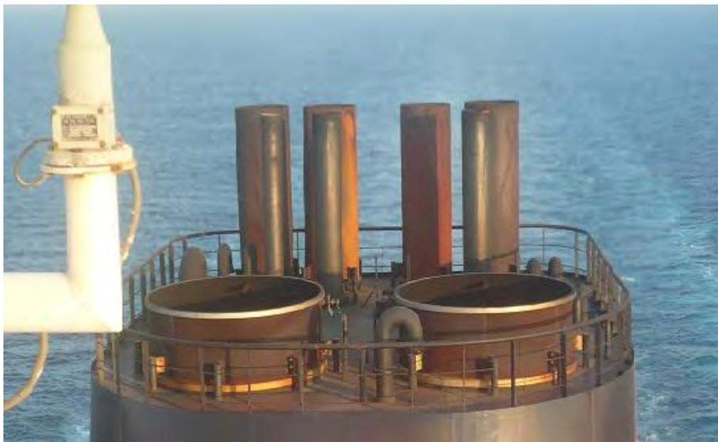
**Ilustración 58** Por donde se expulsa el LNG ya quemado en la GCU. Fuente: elaboración propia
