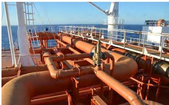
Ilustración 45 Línea de líquido a la altura del Manifold. Fuente: elaboración propia
