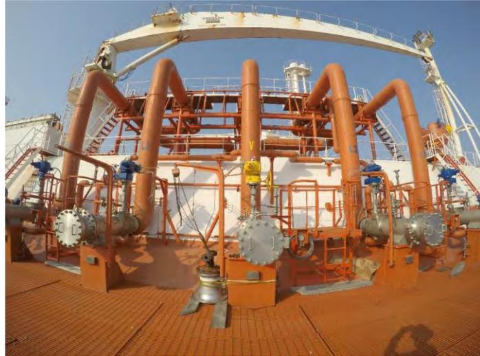
**Ilustración 36** Ejemplo de Manifold con 4 conexiones de líquido y una (la central) de vapor.
