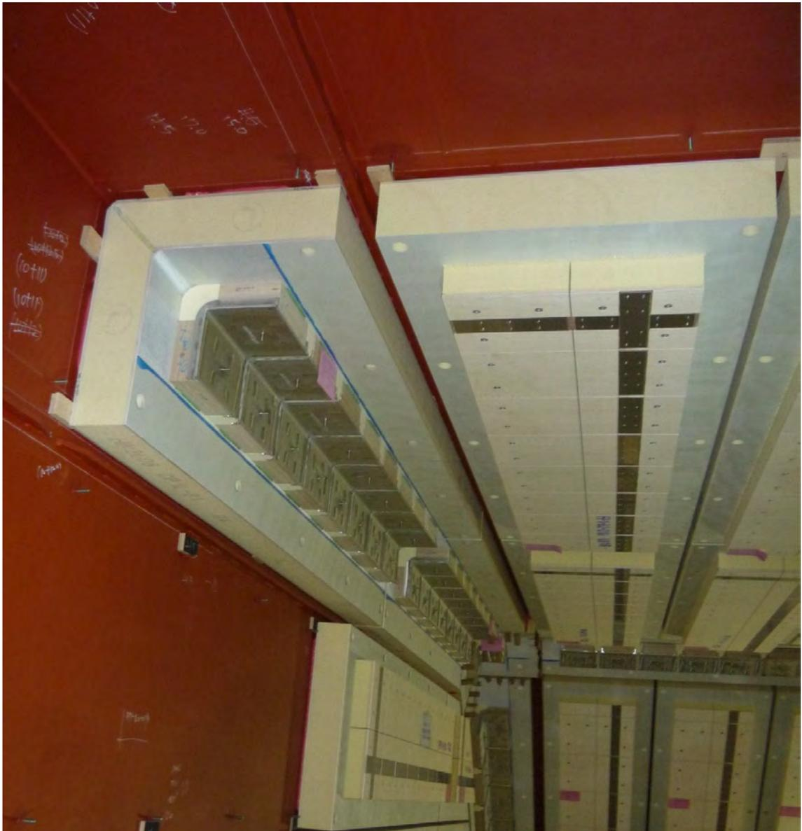
**Ilustración 27** Detalle de los listones donde se apoya la chapa de acero, el espacio aislante y la barrera secundaria de un sistema Mark III. Fuente: elaboración propia
