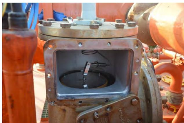
**Ilustración 100 Detalle del flotador. Fuente: elaboración propia**
