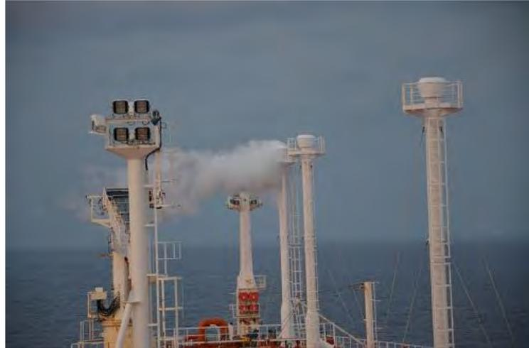
Ilustración 50 Palo de venteo venteando LNG por exceso de presión dentro de un tanque.
