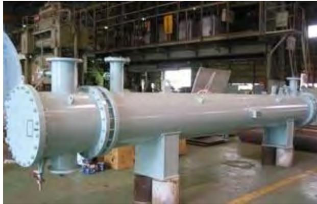
Ilustración 9: Cargo Heater / Vaporizer (Interior)<sup>17</sup>
