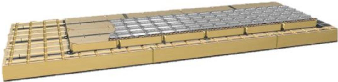
*Figura 25. Diseño del sistema de aislamiento Mark V. Fuente: (Gaz Transport & Technigaz, 2017).*
