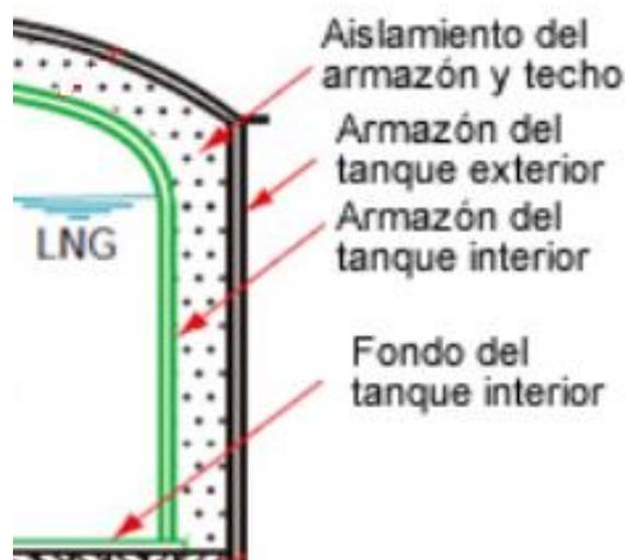
*Figura 2. Vista de la sección transversal del fondo plano de un tanque con doble pared. Fuente: (Kobelco Welding, 2017).*
