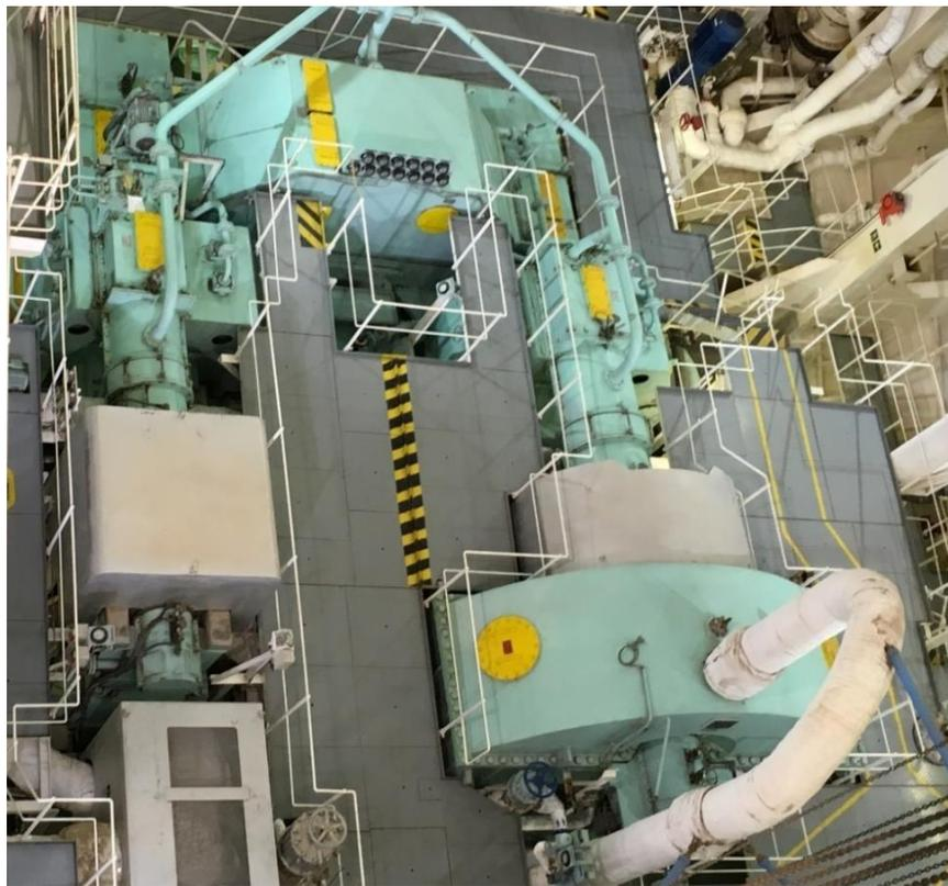
*Figura 14. Turbinas de alta y baja presión y reductora. Fuente: (Propia).*
